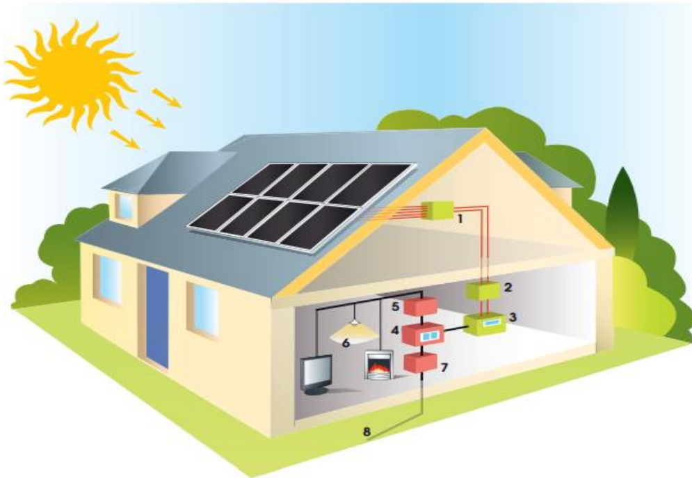
Slika 3.3.1 Sustav solarne elektrane spojen na mrežu[12]
