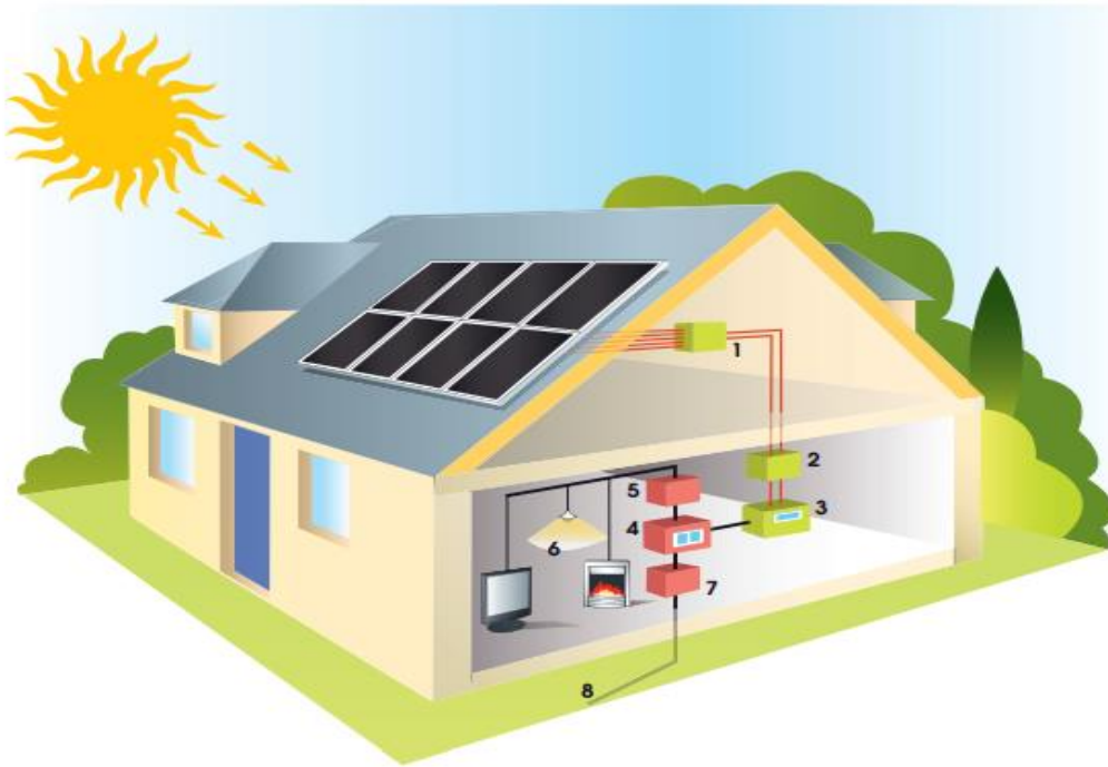
Slika 3.3.1 Sustav solarne elektrane spojen na mrežu[12]
