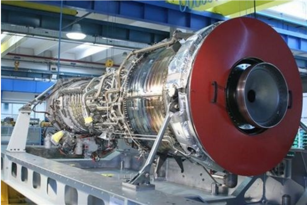
Slika 5.3.4. Plinska turbina GE LM2500
