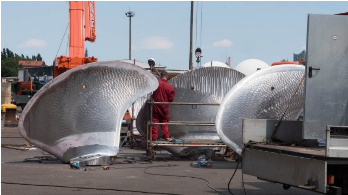
Slika 5.5.3. Nova krila za propelere firme Rolls Royce
