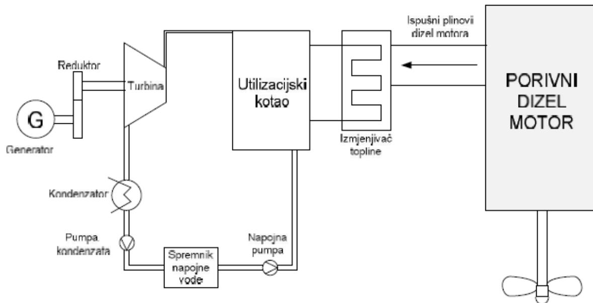
*Slika 4.3.2. Blok shema utilizacijskog postrojenja s turbogeneratorom*
