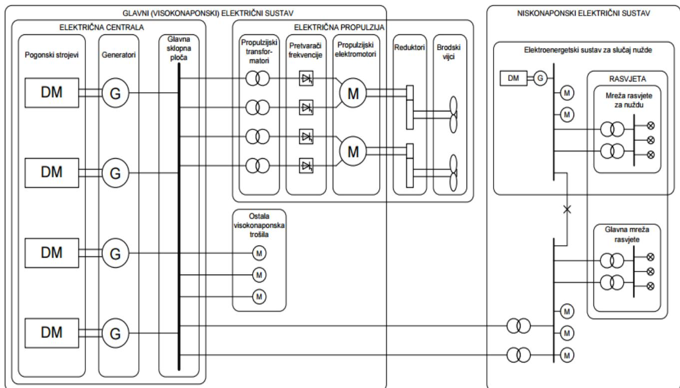
Slika 4.3.6. jednopolna shema Integriranog elektroenergetskog sustava
