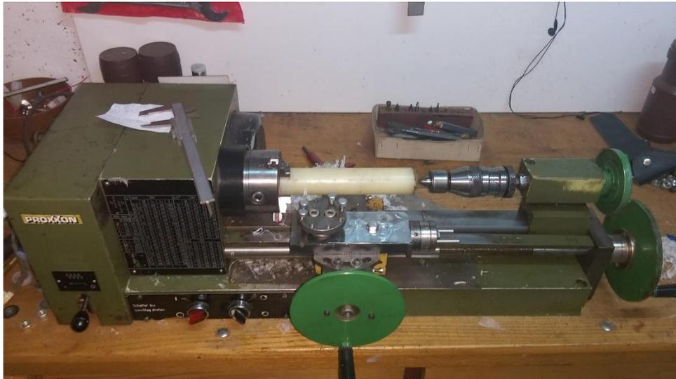
*Sl.4.11. Postupak izrade kućišta zavojnice*
