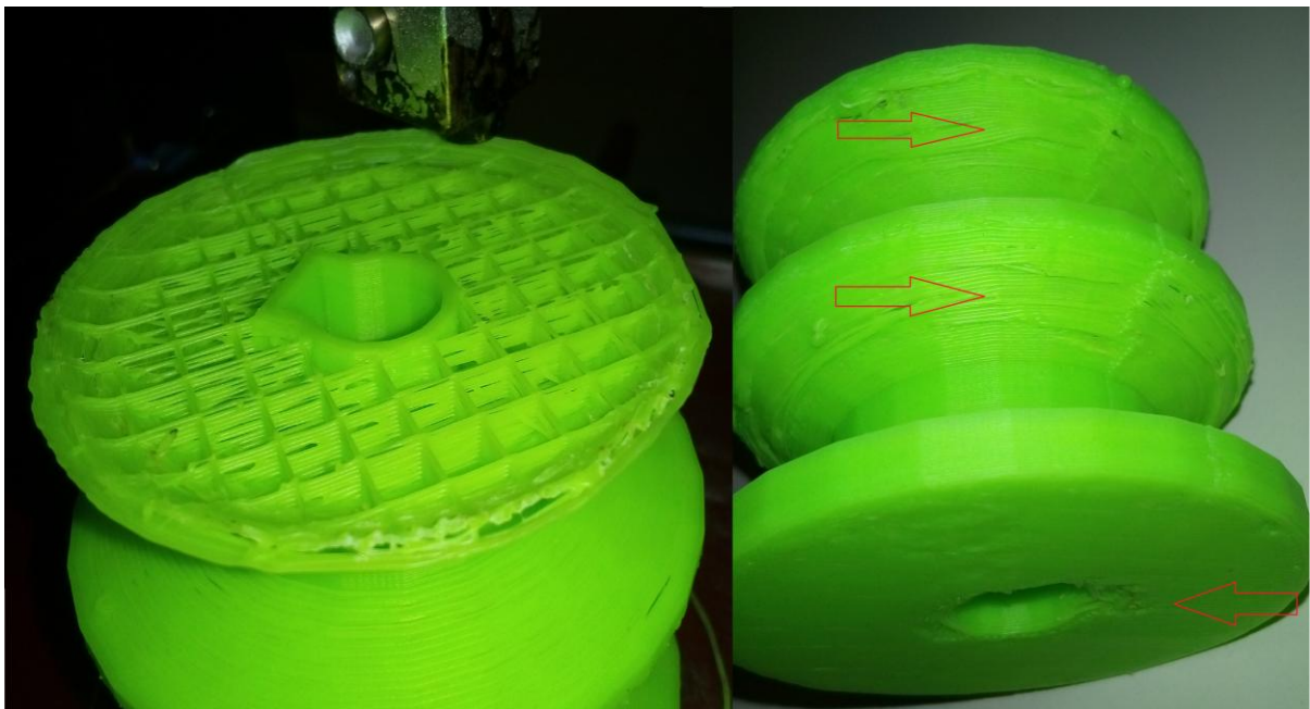
Slika 5.8. Površinske deformacije [vlastiti izvor]
