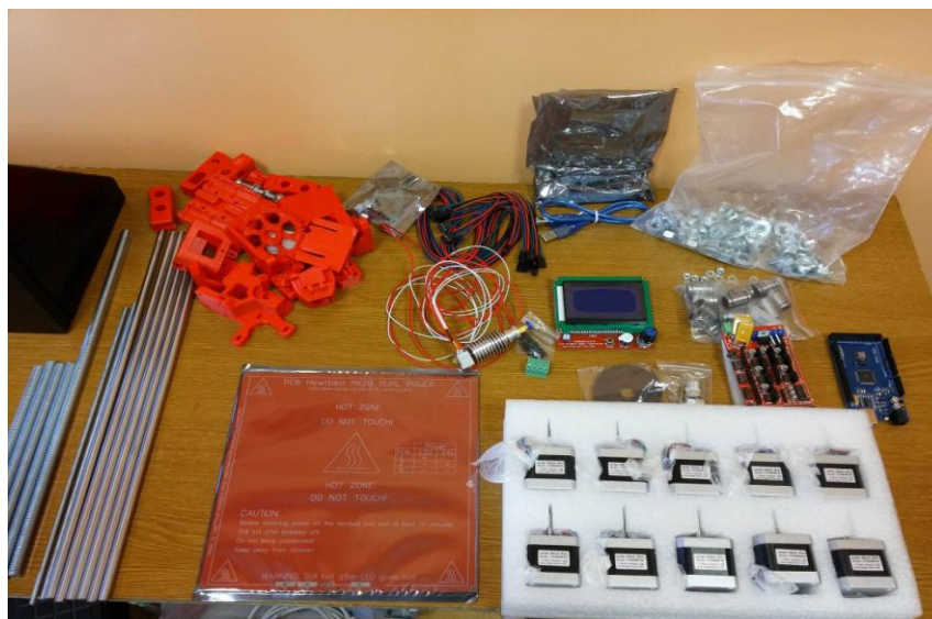
Slika 4.4. Komponente 3D pisača [vlastiti izvor]
