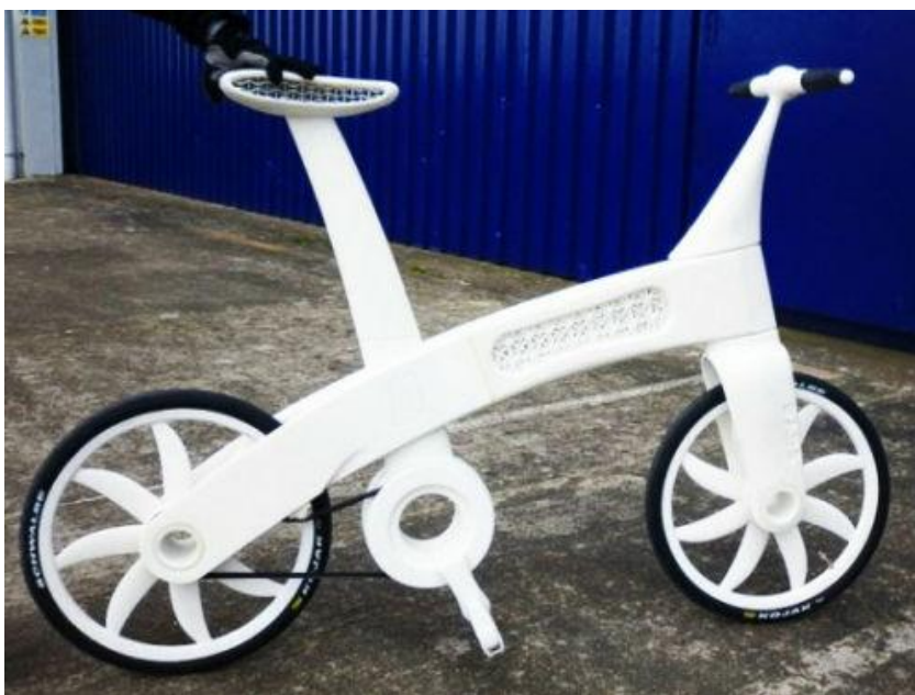
Slika 2.2. Bicikl napravljen na 3D printeru [14]
