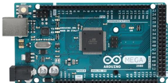
Sl. 2.3. Arduino Mega maketa s ATmega2560 mikroupravljačem
