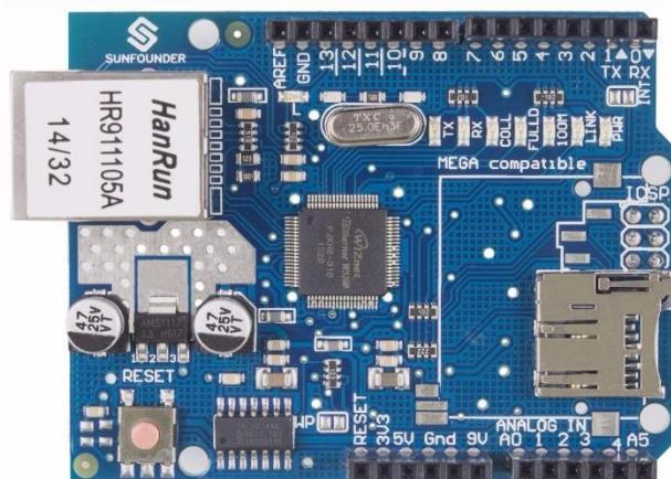
Sl. 2.4. Arduino Ethernet Shield sa Wiznet W5100
