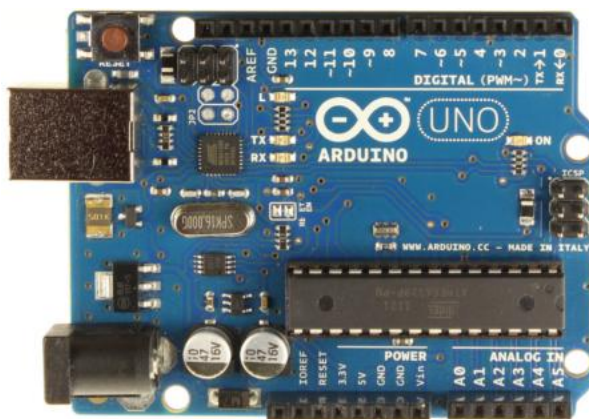
Sl. 2.2. Arduino Uno maketa s ATmega328 mikroupravljačem
