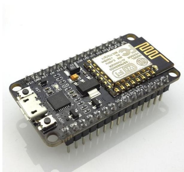
Sl. 2.9. NodeMCU (ESP8266)
