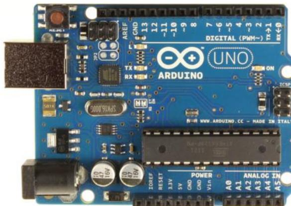
Sl. 2.2. Arduino Uno maketa s ATmega328 mikroupravljačem
