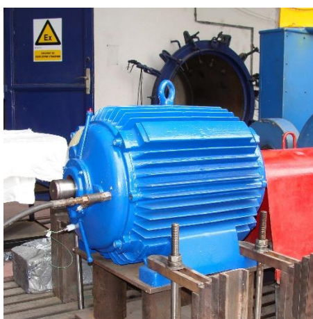
Sl. 4.6. Primjer „Ex e“ motora ispitivanog u eksplozivnoj atmosferi.[4]
