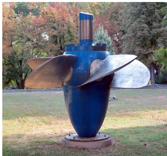
Slika 2.8. Izgled Kaplanove turbine
