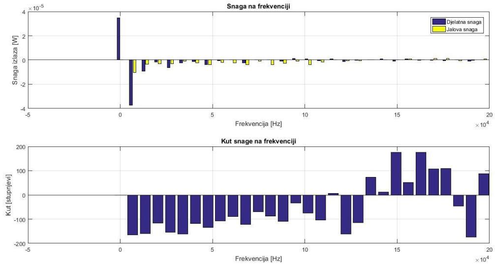
**Slika 5.16.** Snage na frekvenciji izlaza za kontinuirani način rada pri ulaznom naponu od 20 V
