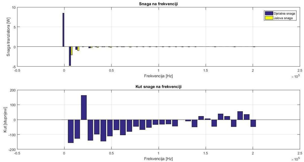
. Slika 5.11. Snage na frekvenciji tranzistora za kontinuirani način rada pri ulaznom naponu od 20 V
