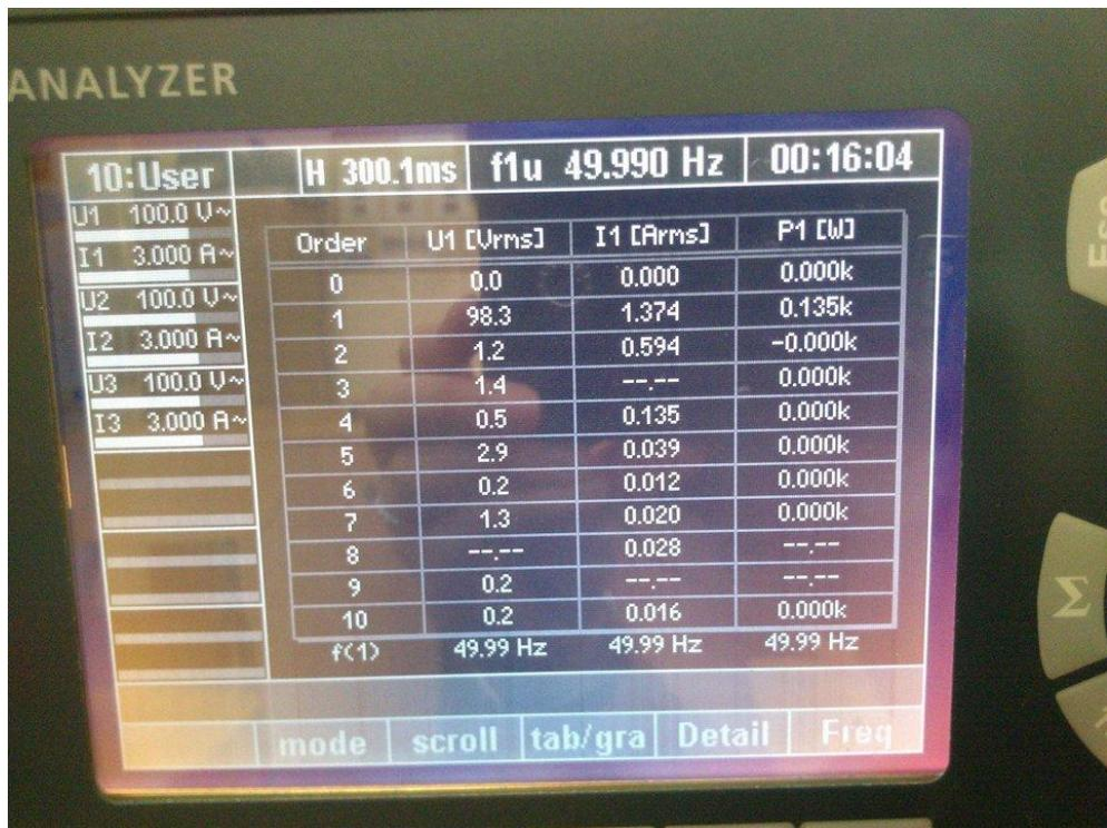
*Slika 3.6. Prikaz mjerenja na valnom analizatoru*
