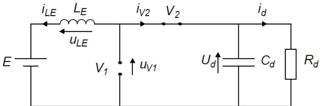
**Slika 4.3.** Nadomjesna shema spoja uzlaznog pretvarača za interval B [6]
