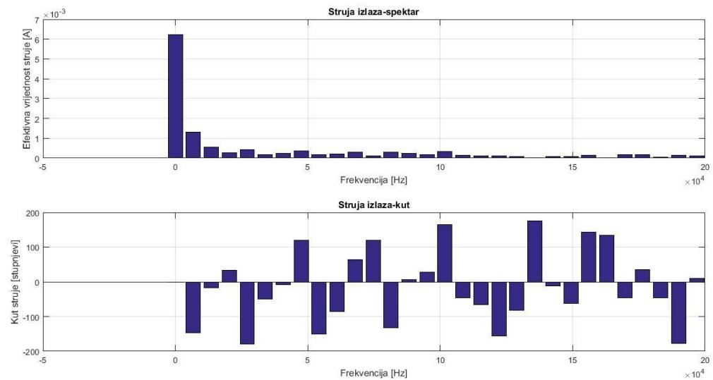
**Slika 5.15.** Spektar struje izlaza za kontinuirani način rada pri ulaznom naponu od 20 V
