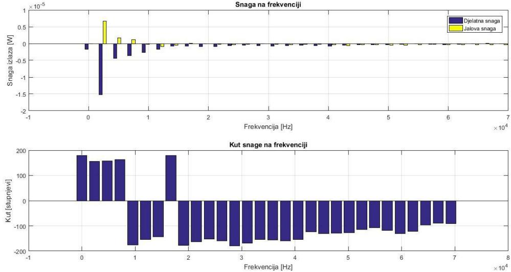
**Slika 5.34.** Snage na frekvenciji izlaza za diskontinuirani način rada pri ulaznom naponu od 21,85 V
