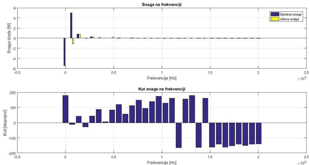
*. Slika 5.5. Snage na frekvenciji diode za kontinuirani način rada pri ulaznom naponu od 20 V*
