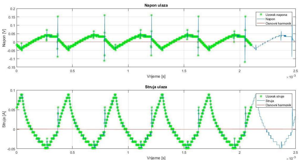
*Slika 5.36.* Valni oblik izmjenične komponente ulaza za diskontinuirani način rada pri ulaznom naponu od 21,85 V
