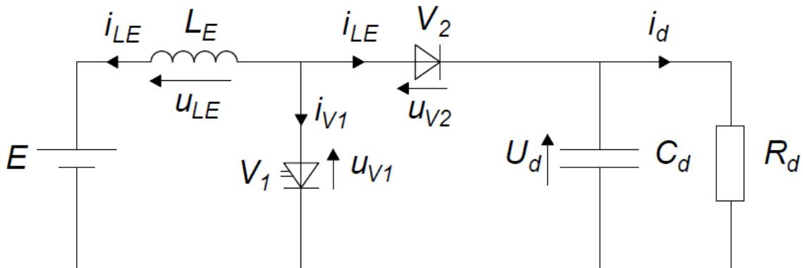
*Slika 4.1.* Nadomjesna shema spoja uzlaznog pretvarača [6]
