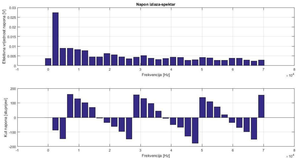
**Slika 5.32.** Spektar izlaznog napona za diskontinuirani način rada pri ulaznom naponu od 21,85 V
