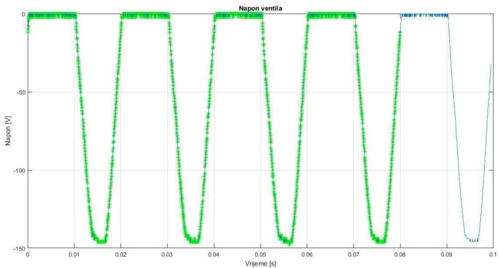
*Slika 3.8. Snimljeni valni oblik napona ventila*
