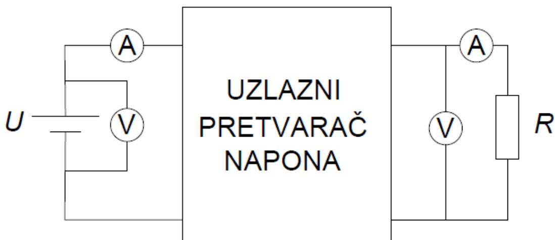
*Slika 5.1. Shema mjerjenja za uzlazni pretvarač*
