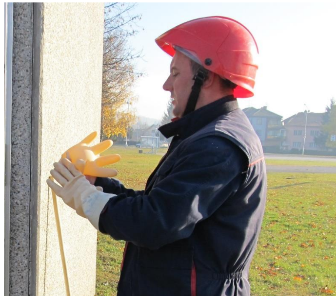
Sl. 3.7. Provjera izolacijskih rukavica napuhivanjem [7]
