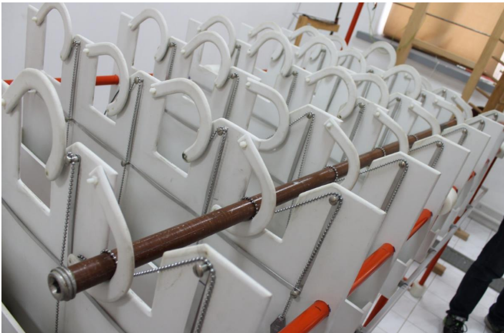
Sl. 3.14. Dielektrično ispitivanje izolacijske motke za RPN
