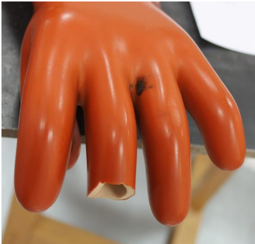
Sl. 3.6. Oštećene kompozitne izolacijske rukavice za RPN
