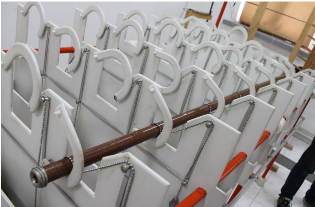
Sl. 3.14. Dielektrično ispitivanje izolacijske motke za RPN
