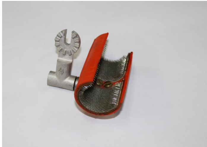
Sl. 4.6. Alat za četkanje, skidanje oksida i nečistoća na površini vodiča
