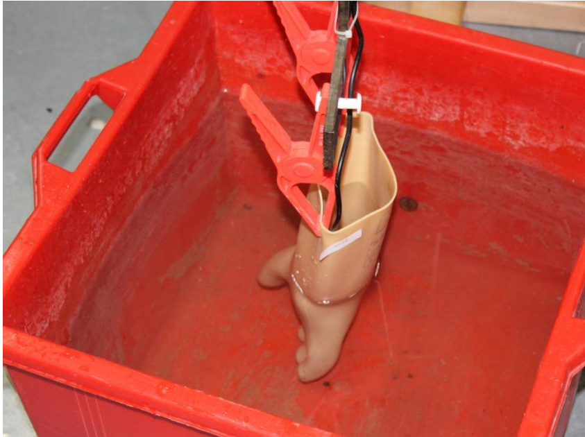
Sl. 3.15. Dielektrično ispitivanje izolacijske rukavice za RPN
