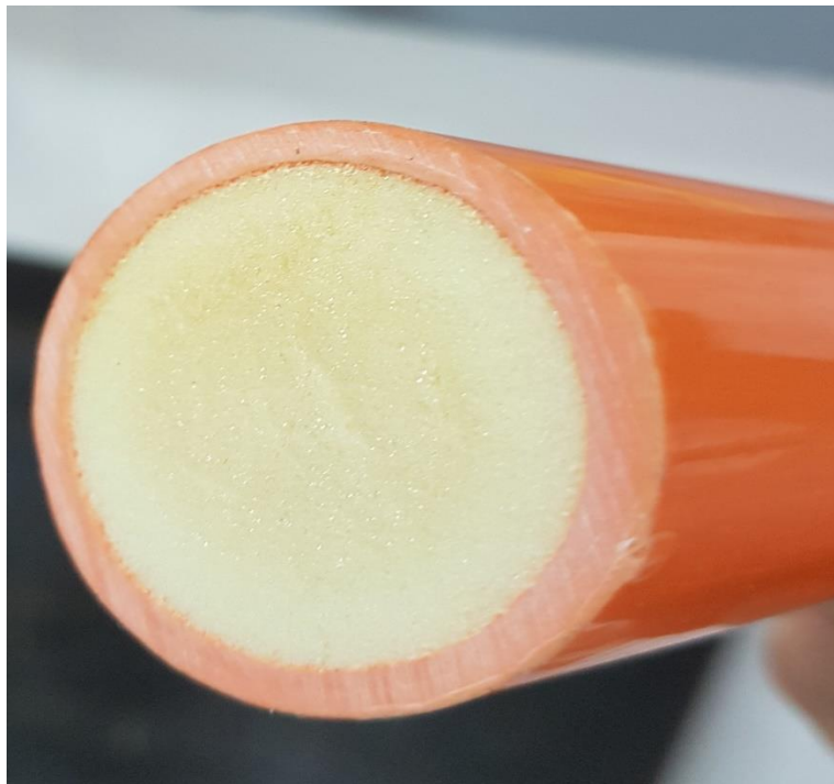
Slika 4.4. Presjek izolacije uzemljivačke motke
