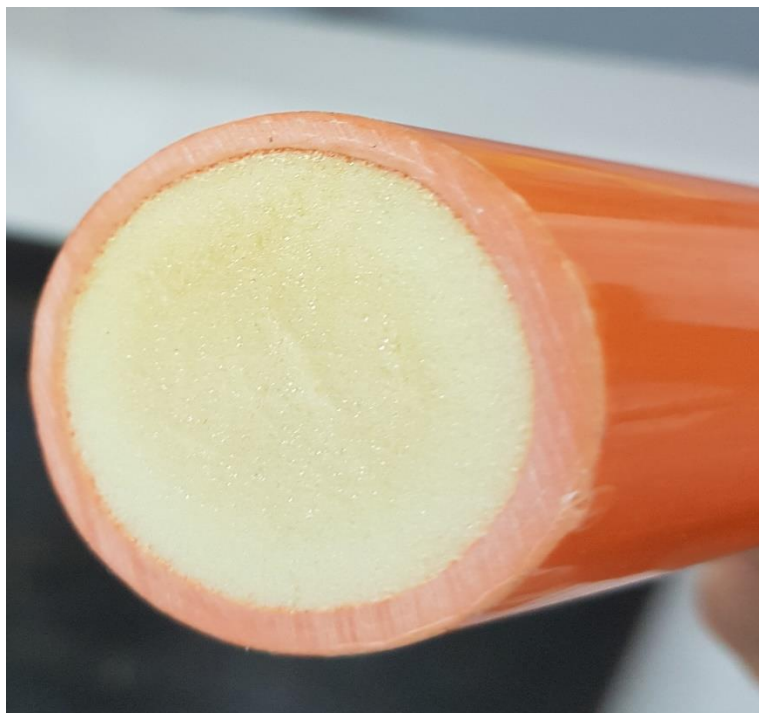
Slika 4.4. Presjek izolacije uzemljivačke motke
