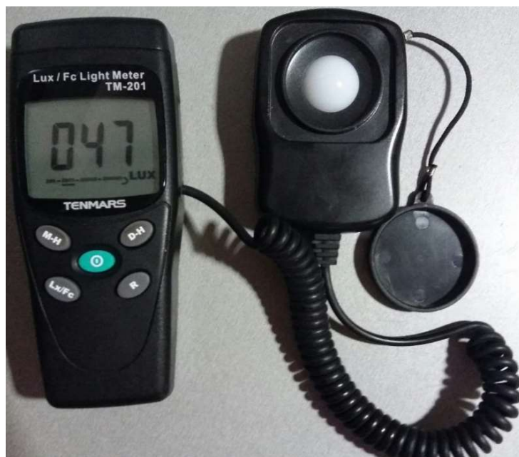
Sl. 3.1.: Mjerni instrument tip TENMARS Lux/Fc Light Meter TM-201
