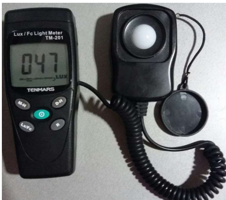
Sl. 3.1.: Mjerni instrument tip TENMARS Lux/Fc Light Meter TM-201
