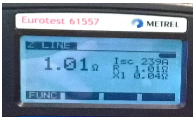
Sl. 5.7. Rezultat mjerenja impedancije petlje jednofazne utičnice 2
