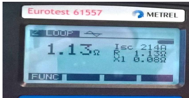
Sl. 5.13. Rezultat mjerenja otpora petlje kvara trofazne utičnice
