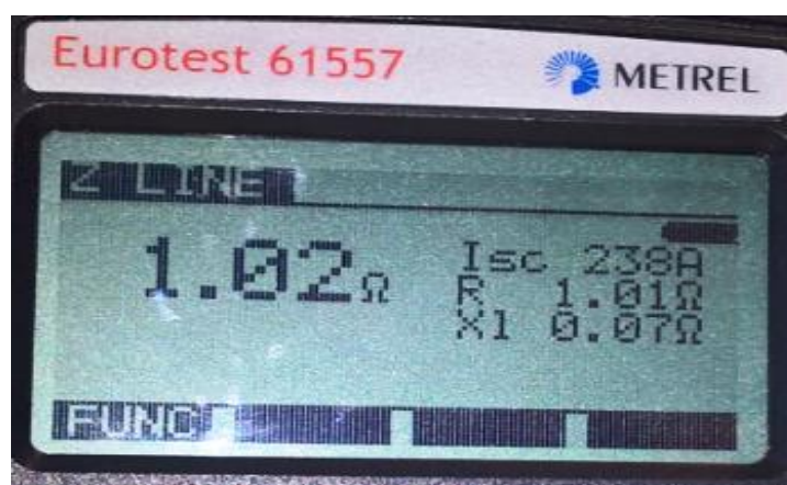
Sl. 5.4. Rezultat mjerenja impedancije petlje trofazne utičnice
