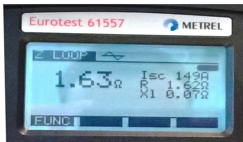
Sl. 5.9. Mjerenje otpora petlje kvara trofaznog motora
