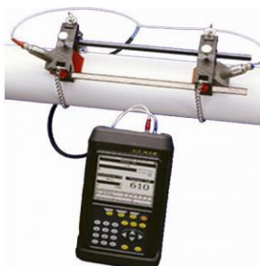
Slika 2.2. Prijenosni uređaj za ultrazvučna mjerenja toka tekućine u cijevi.[4]
