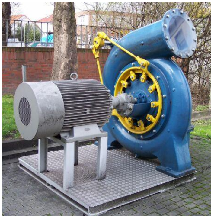
Slika 3.8. Francisova turbina manje snage, [15]
