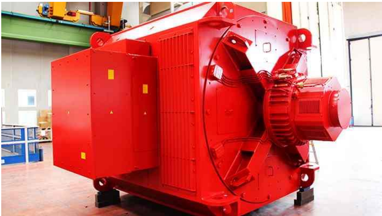
Slika 4.1. Tvorničko sastavljeni generator, [25]
