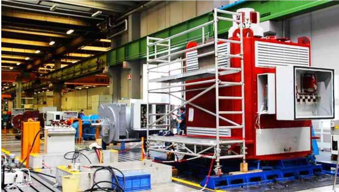
Slika 4.6. Tvorničko ispitivanje hidrogeneratora, [25]
