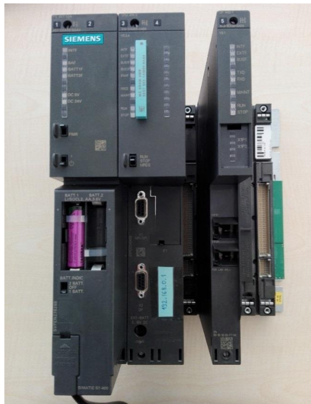
Slika 3.2. Glavni okvir PLC-a sa CPU-om S7 414-3 DP
