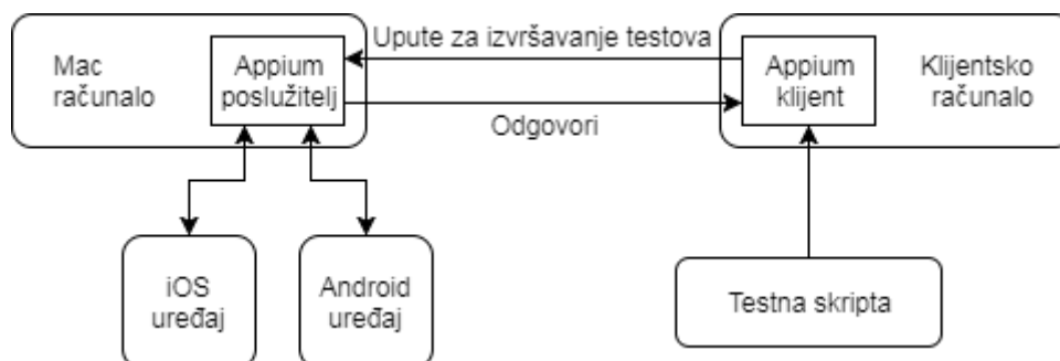
Sl. 3.1. Dijagram testnog okruženja.
