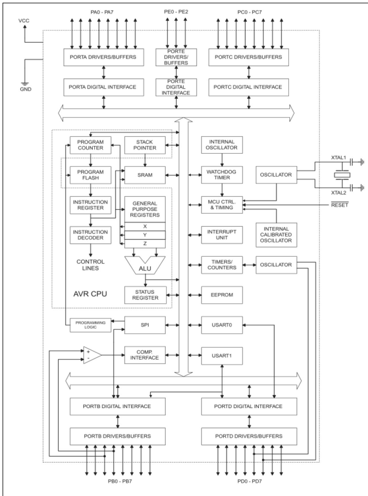
Slika 3.4. Blok dijagram ATmega162 mikroupravljača
