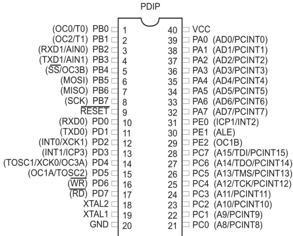
**Slika 3.5.** Raspored pinova *ATmega162* mikroupravljača
