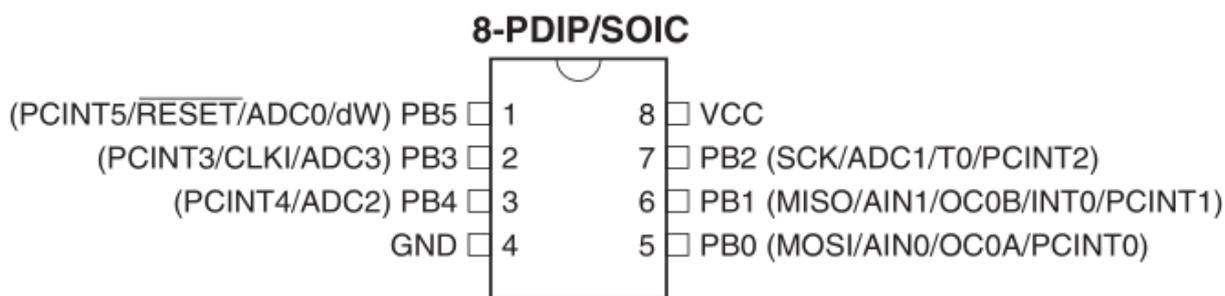
**Slika 3.6.** Raspored pinova ATtiny13 mikroupravljača
