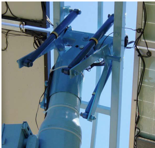
Slika 3.2. Glava Zomeworkovog pasivnog sustava za praćenje [9]
