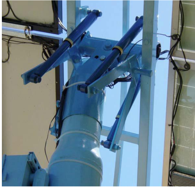
Slika 3.2. Glava Zomeworkovog pasivnog sustava za praćenje [9]
