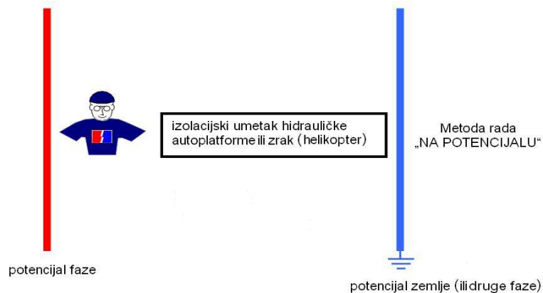
Slika 3.8. Zaštitni elementi tijekom RPN u metodi „na potencijalu“ [1]
