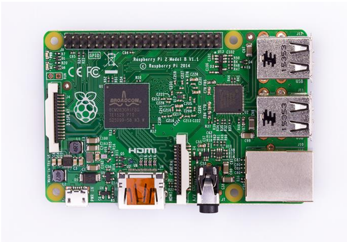
Sl. 3.1. Raspberry Pi 2 B razvojna platforma
