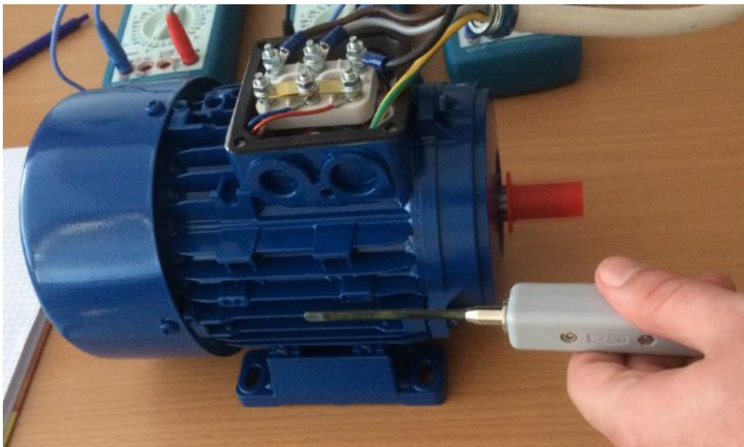
Sl. 4.15. Mjerenje magnetske indukcije izmjeničnog motora
