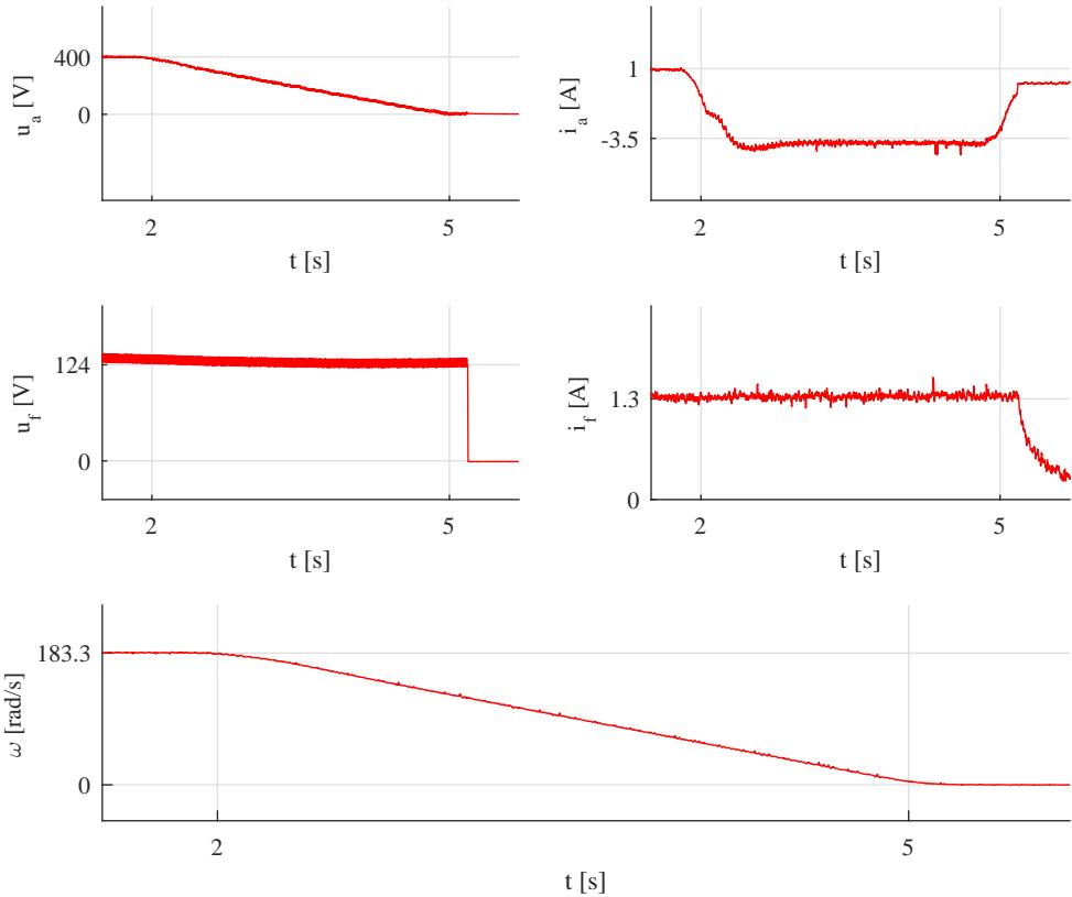
**Sl. 4.4:** Snimljeni valni oblici za kočenje regulirano istosmjernog motora
