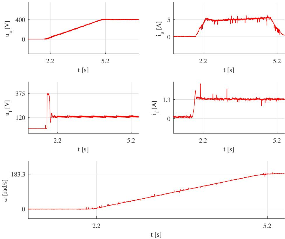
**Sl. 4.2:** Snimljeni valni oblici za zalet reguliranog istosmjernog motora
