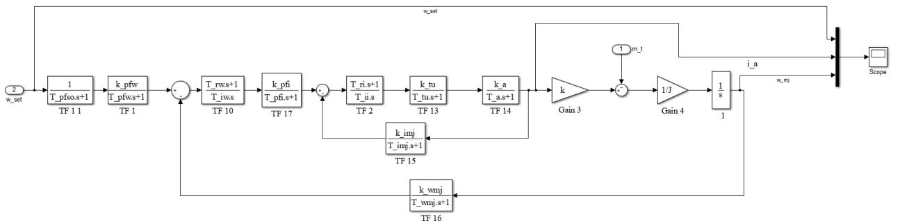
**Sl. 2.15:** Simulacijski model reguliranog istosmjernog motora
