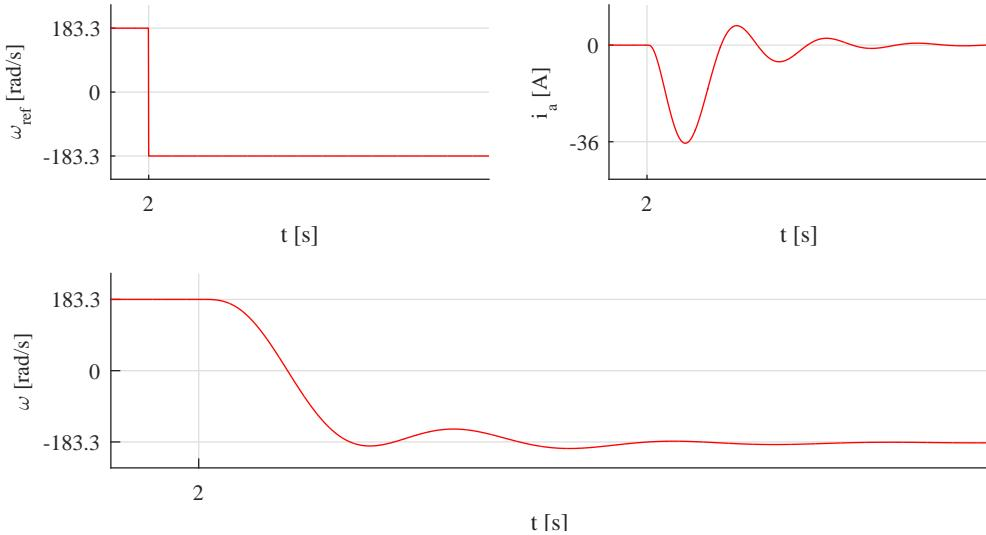
**Sli. 2.25:** Rezultati simulacije reverziranja reguliranog istosmjernog motora za skokovitu promjenu referne veličine
