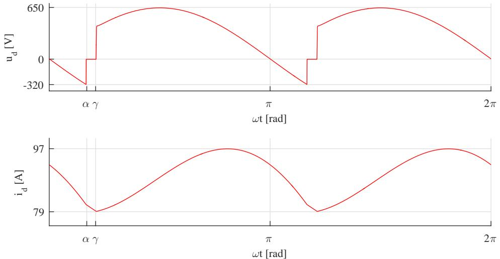
**S1. 3.8:** Valni oblik napona i kontinuirane struje pri  $\alpha = 30^\circ$  i  $L_c > 0$
