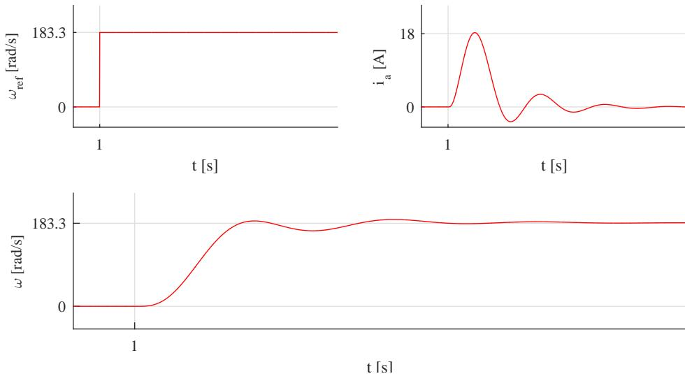
**Sl. 2.20:** Rezultati simulacije zaleta reguliranog istosmjernog motora za skokovitu promjenu referne veličine
