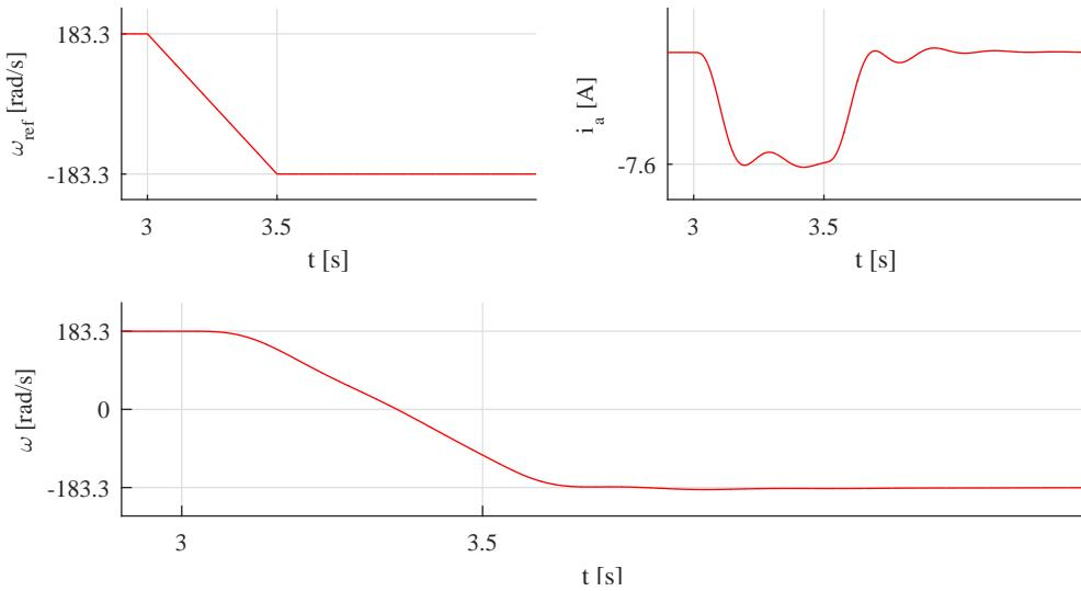
**Sli. 2.26:** Rezultati simulacije reverziranja reguliranog istosmjernog motora za linearnu promjenu referne veličine
