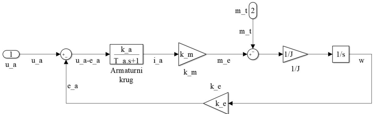
Sl. 2.4: Blok dijagram nereguliranog istosmjernog motora
