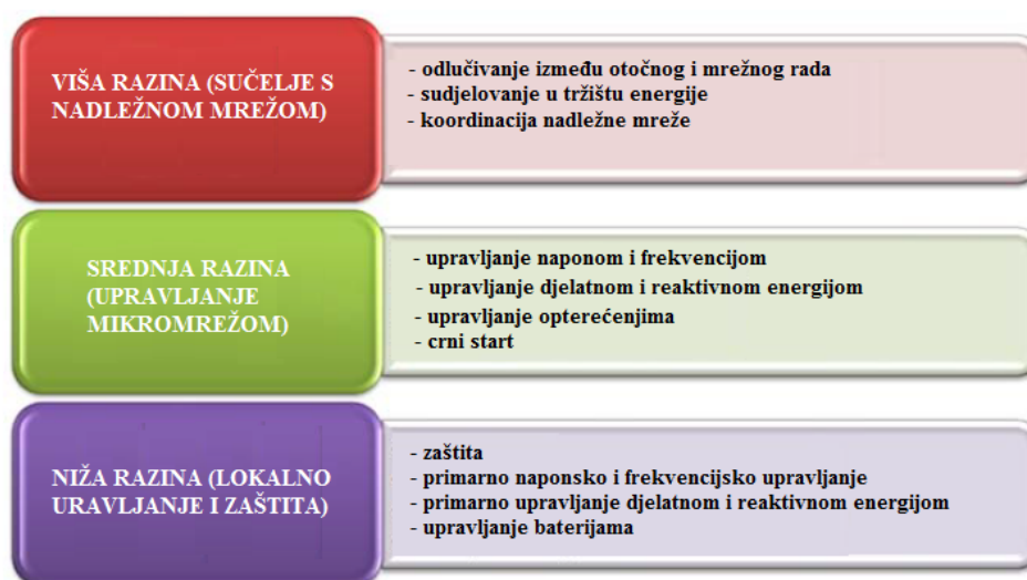
Sl. 2.10. Upravljačke funkcije cjelokupnog sustava [1].
