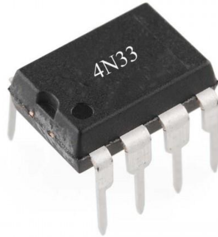
Sl. 4.10. Unutarnja shema i realni izgled optoizolatora 4N33 [5].
