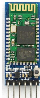
Slika 3.2.1.8. HC-05 Bluetooth module
