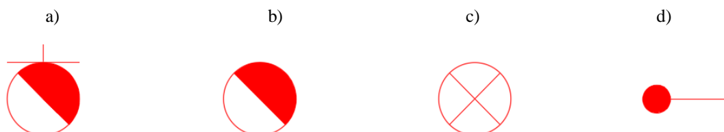
Sl. 3.22. Simboli za izvod za zidnu rasvjetu (a), stropnu rasvjetu (b), plafonijeru (c) i nadsvjetlo u kupaonici (d).
