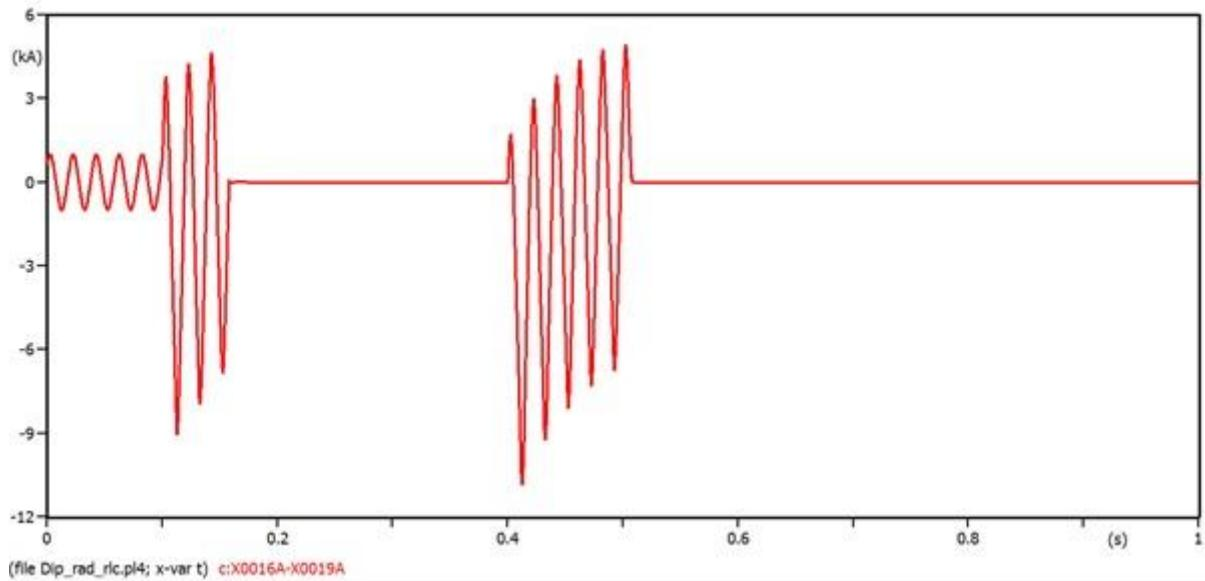
S1. 5.8. Valni oblik struje faze A generatora pri jednofaznom kratkom spoju
