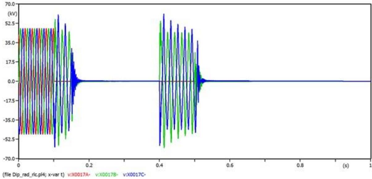
Sli. 5.10. Valni oblici napona pojedinih faza na mjestu kvara pri jednofaznom kratkom spoju
