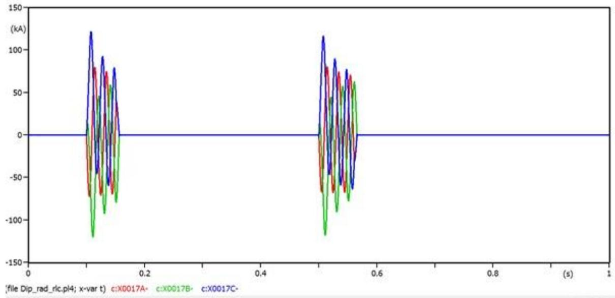
Sl. 5.30. Valni oblici struja pojedinih faza na mjestu kvara pri trofaznom kratkom spoju
