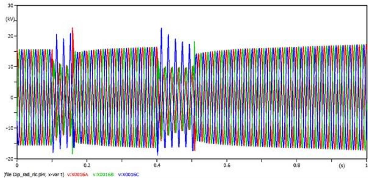
Sl. 5.7. Valni oblik napona pojedinih faz generatora pri jednofaznom kratkom spoju
