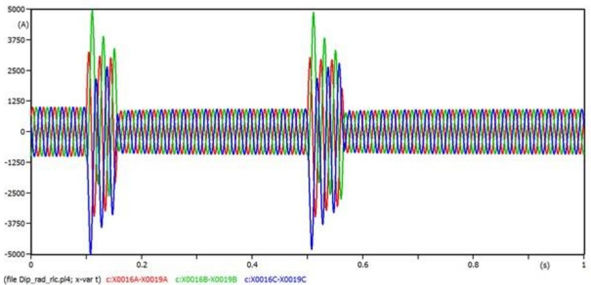
Sl. 5.29. Valni oblici struja pojedinih faza generatora pri trofaznom kratkom spoju
