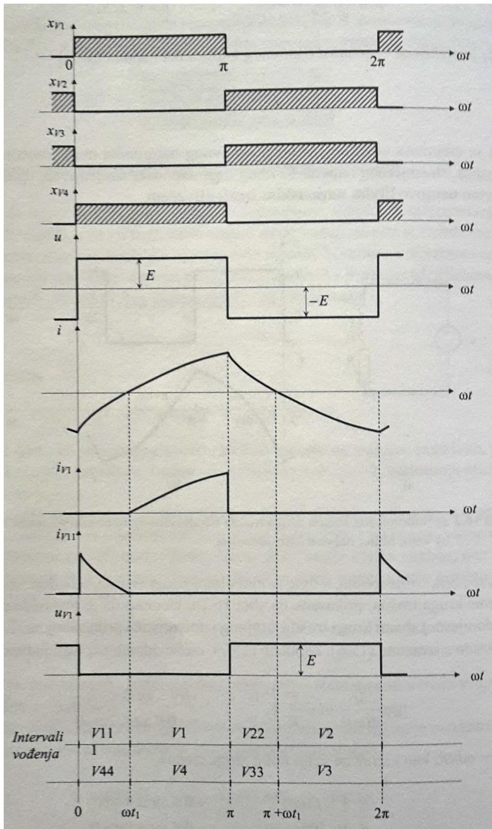
Slika 2.5. Karakteristični valni oblici napona i struja neupravljivog naponskog izmjenjivač
