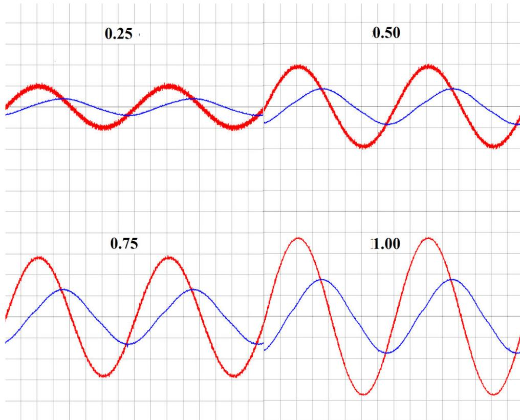
**Slika 4.30.** Usrednjeni valni oblici struje i napona izmjenjivača pri četiri različita modulacijska indeksa, frekvencija 50 Hz, radno-induktivno opterećenje, sklopna frekvencija 977 Hz, sinusna bipolarna pulsno-širinska modulacija
