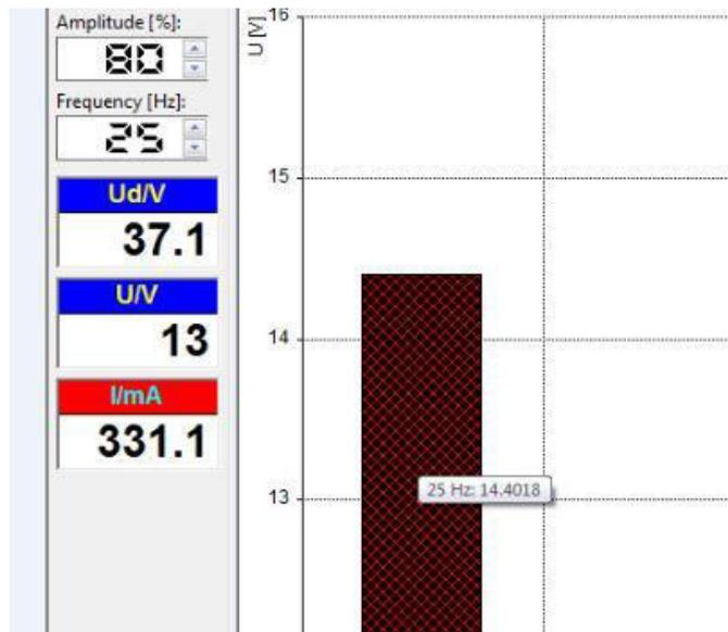
Slika 4.34. Vršna vrijednost osnovnog harmonika napona, amplituda 80%,  $m_f=39,08$
