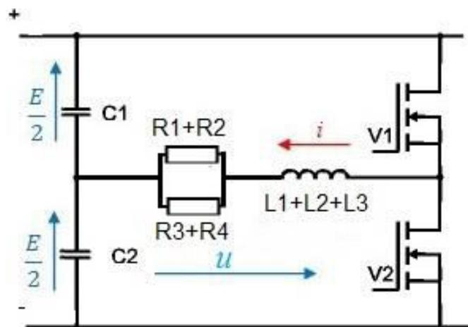
**Slika 3.10.** Shema spajanja jednofaznog neupravljivog naponskog izmjenjivača
