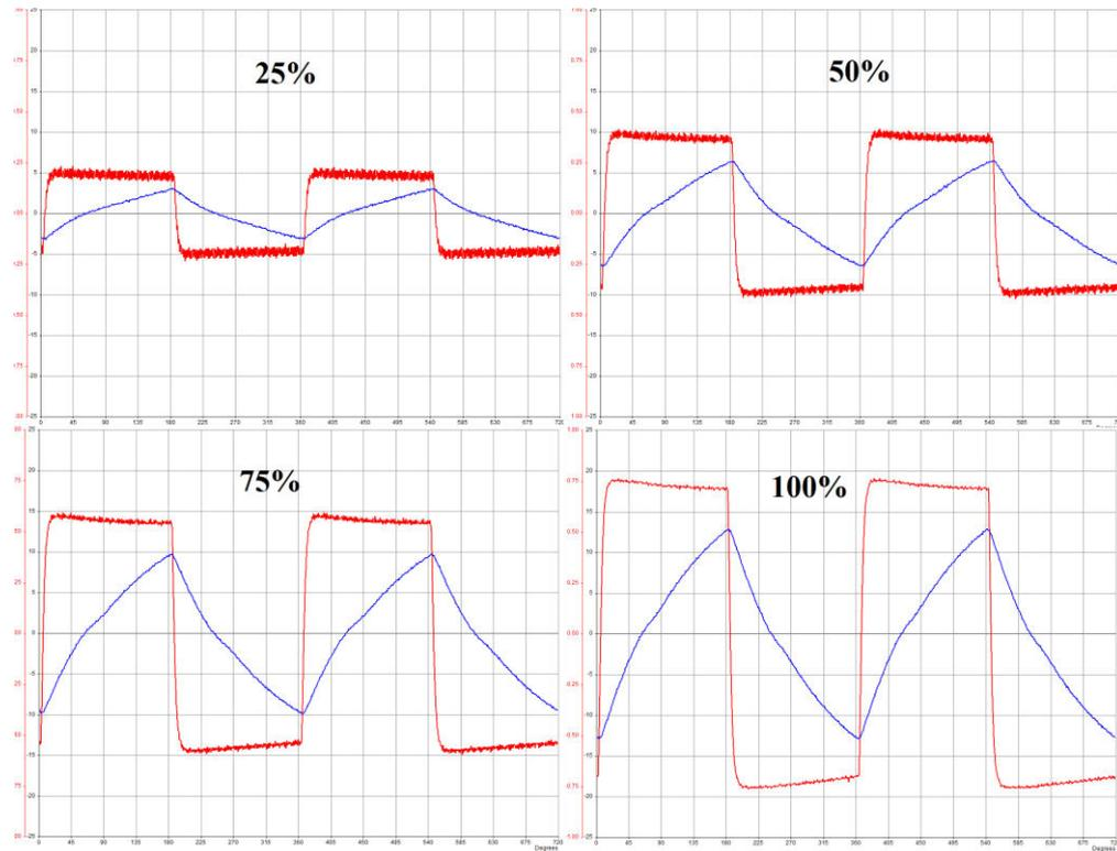
**Slika 4.9.** Usrednjeni valni oblici struje i napona izmjenjivača, amplitude (25%, 50%, 75%, i 100%), frekvencija 50 Hz, radno-induktivno opterećenje, sklopna frekvencija 7810 Hz, pravokutna modulacija
