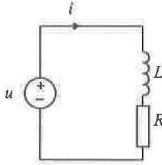
**Slika 2.4.** Nadomjesna shema kruga trošila neupravljivog naponskog izmjenjivača
