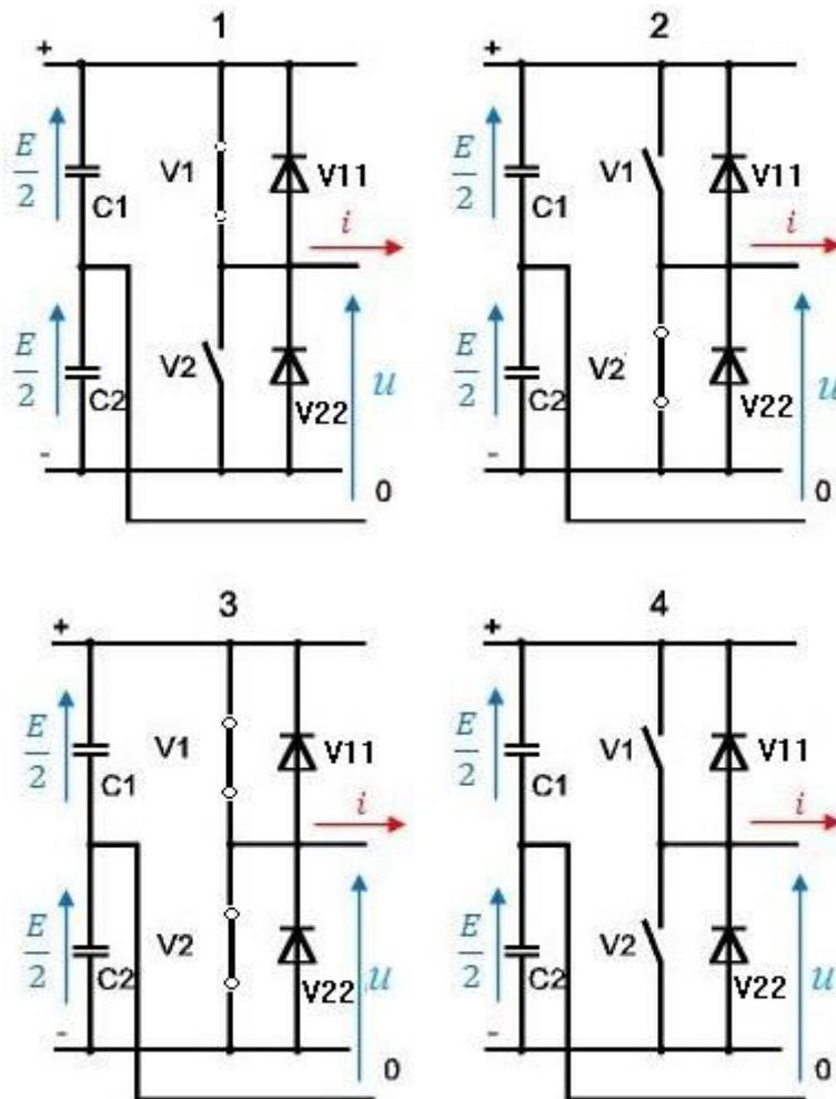
**Slika 3.8.** *Moguća sklopna stanja neupravljivog naponskog izmjenjivača*
