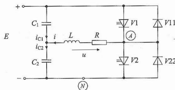
**Slika 2.6.** Shema jednofaznog izmjenjivača u polumosnom spoju.
