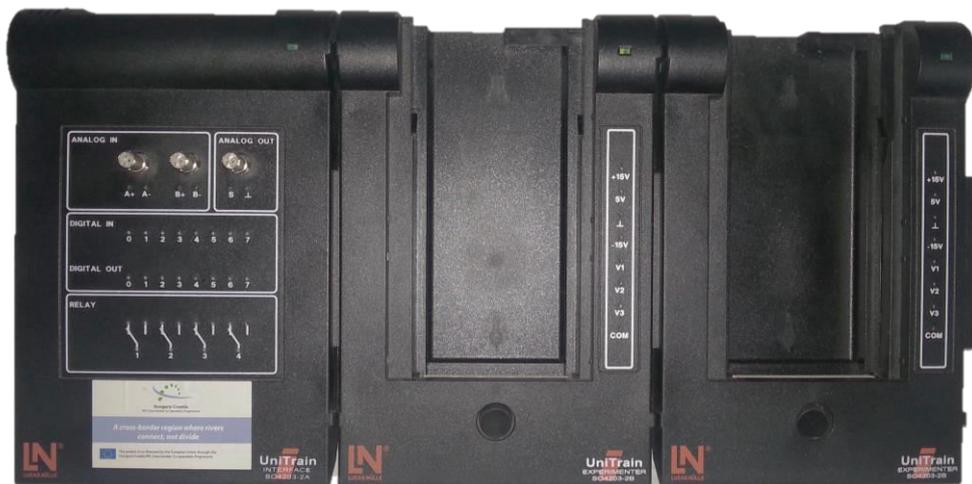
**Slika 3.1.** Sučelje mjerne opreme s pripadajućim eksperimentatorima
