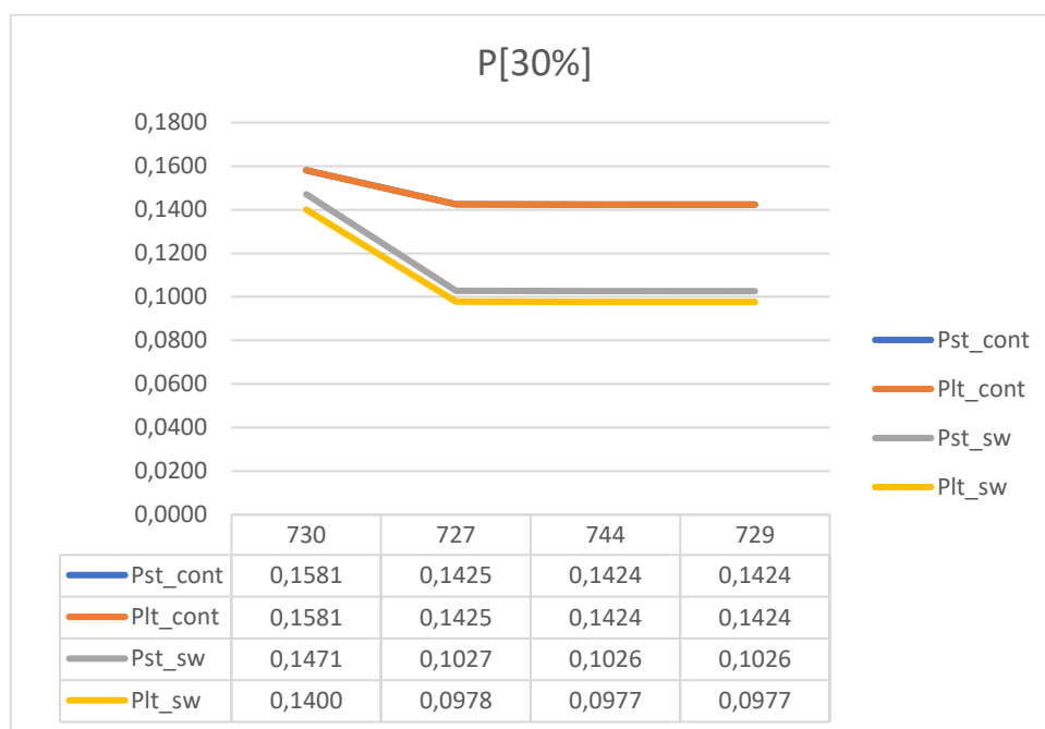
Graf 5.40. Prikaz promjene faktora treperenja na karakterističnim sabirnicama za izlaznu snagu agregata iznosa 30% ukupnog opterećenja
