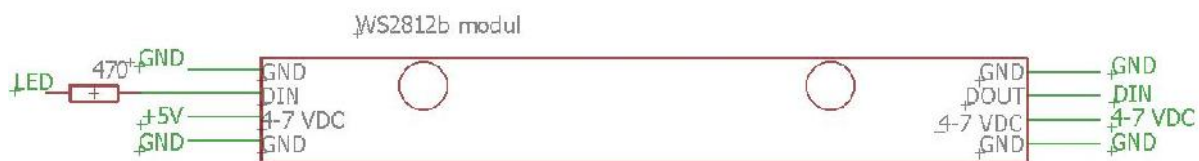
SI 3.9. Shema spajanja LED modula
