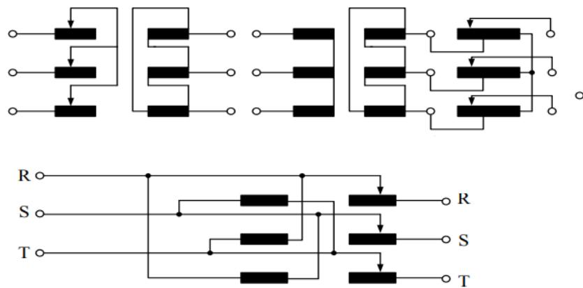
Slika 2.7.3.2. Regulacija napona na transformatoru [14]
