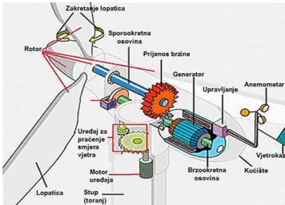
Slika 2.2.1 Dijelovi vjetroagregata [8]
