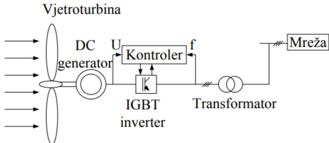
Slika 2.12.1. Istosmjerni sustav [19]
