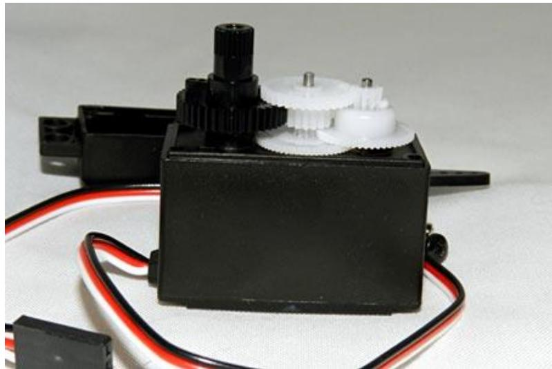
*Slika 2.5 Zupčanici u servo motoru, [2]*
