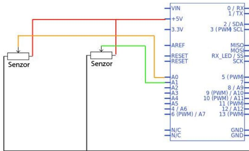
*Slika 3.9 Primjer spajanja senzora jednog prsta upravljačke rukavice*
