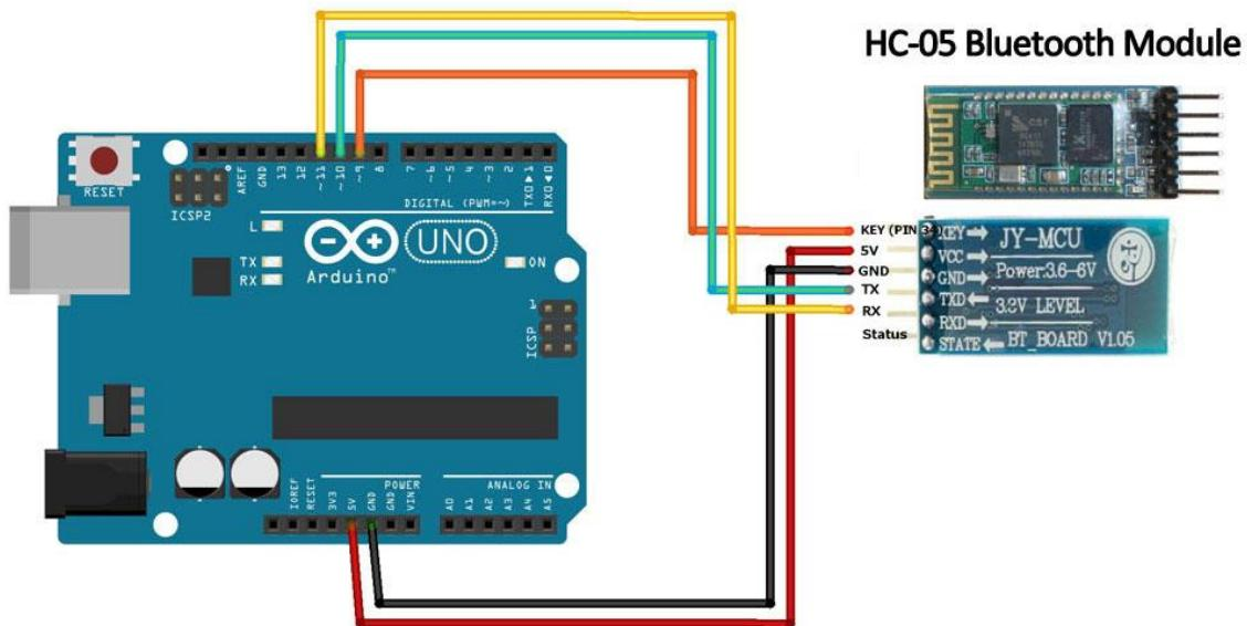
Slika 2.15 Spajanje modula za AT način rada
