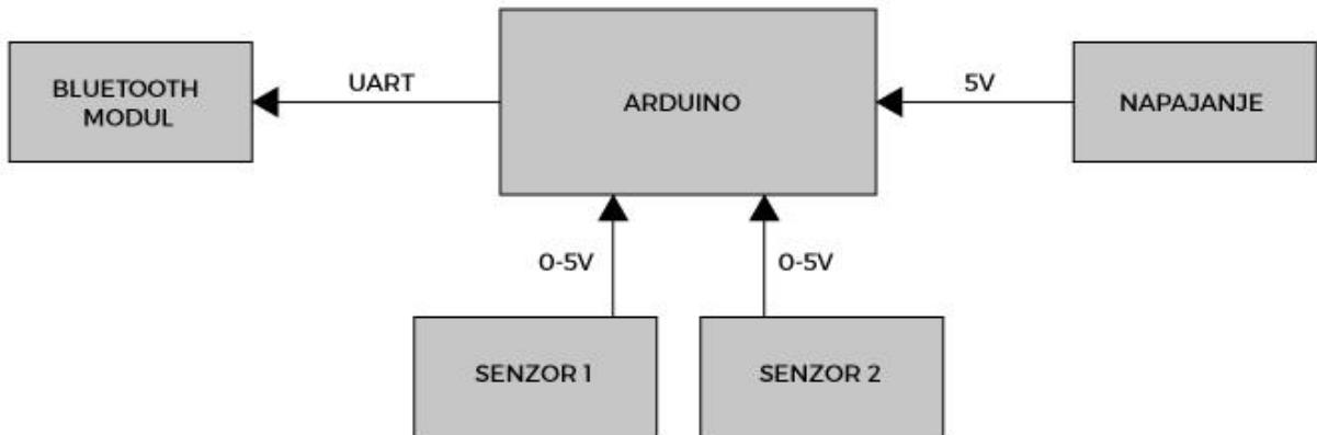
Slika 3.10 Blok shema upravljačke rukavice
