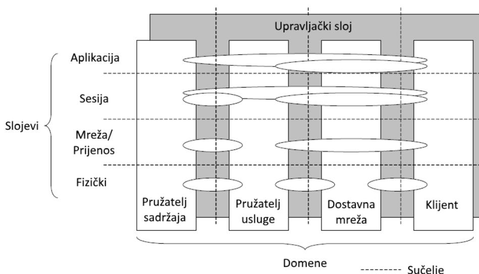
**Slika 2.2.** Slojeviti model IP DTV usluga [11, str. 32]
