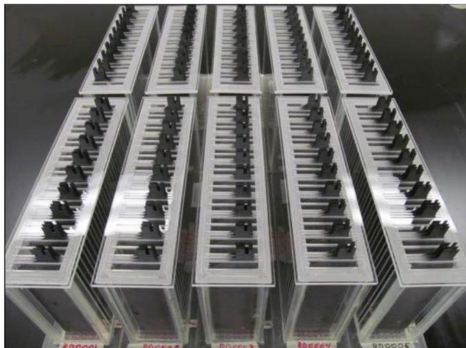
Slika 6.14. Prototip cink-zrak baterije [4]
