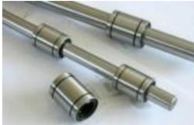
Slika 3.1. Linearne okrugle vodicice s linearnim ležajevima
