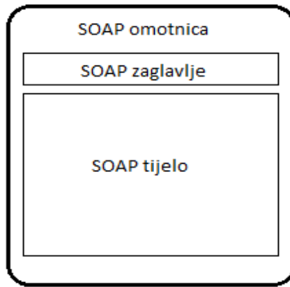
Slika 2.1. – Dijelovi SOAP poruke
