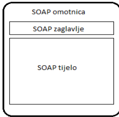
Slika 2.1. – Dijelovi SOAP poruke
