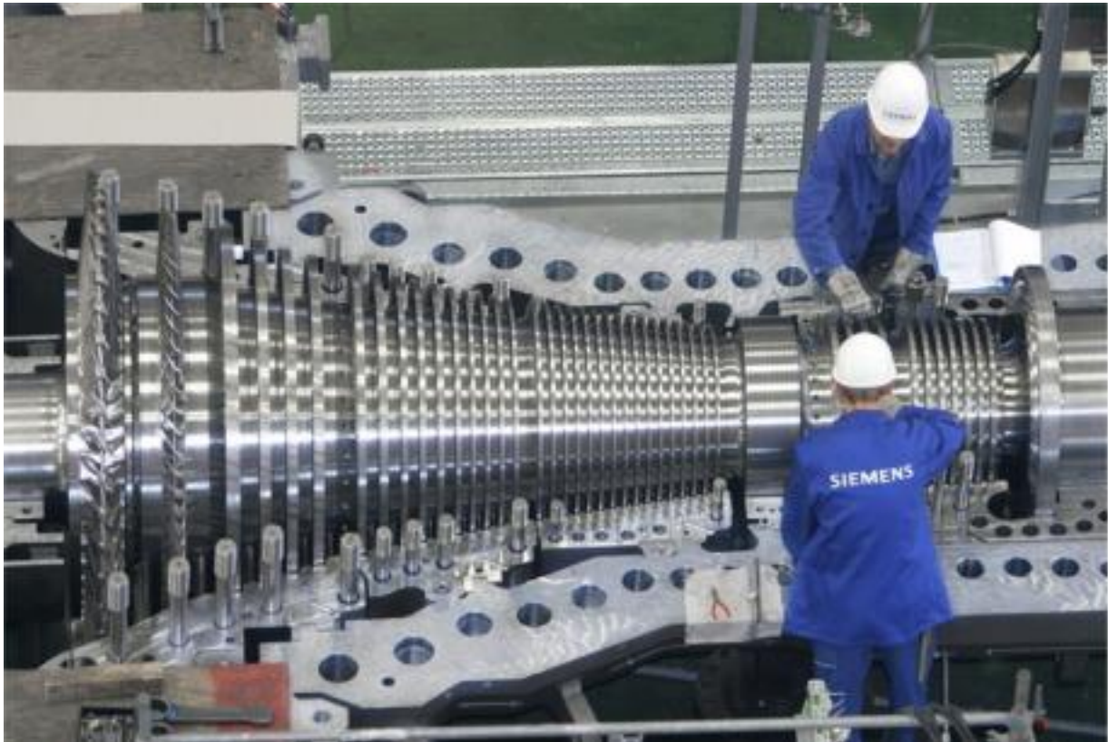
Sl.2.8. Parna turbina [8].
