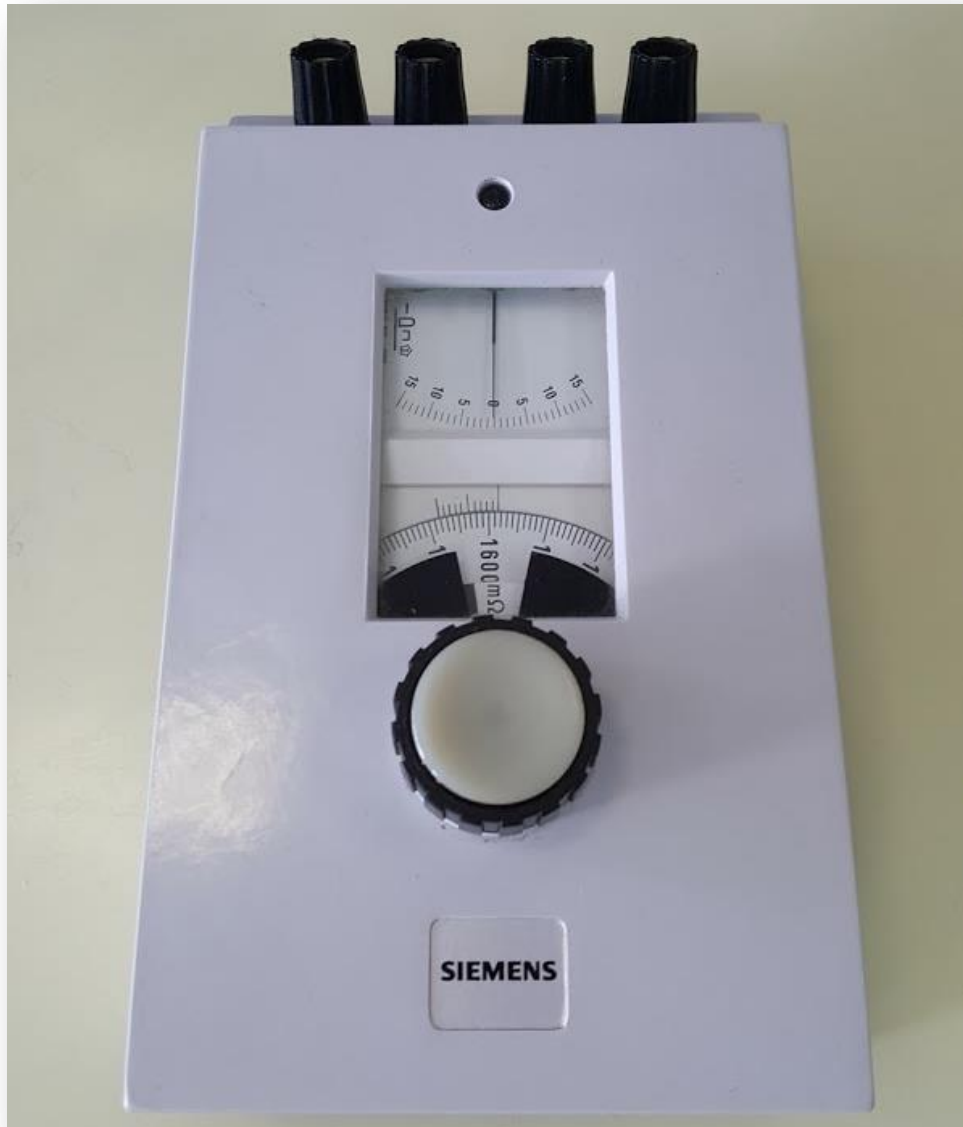
Slika 16 Laboratorijska izvedba Thomsonovog mosta.
