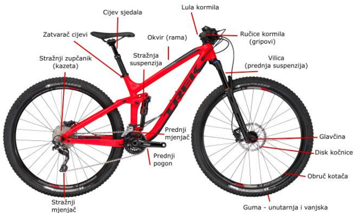
Sl. 3.19. Sastavni dijelovi modernog bicikla [14]
