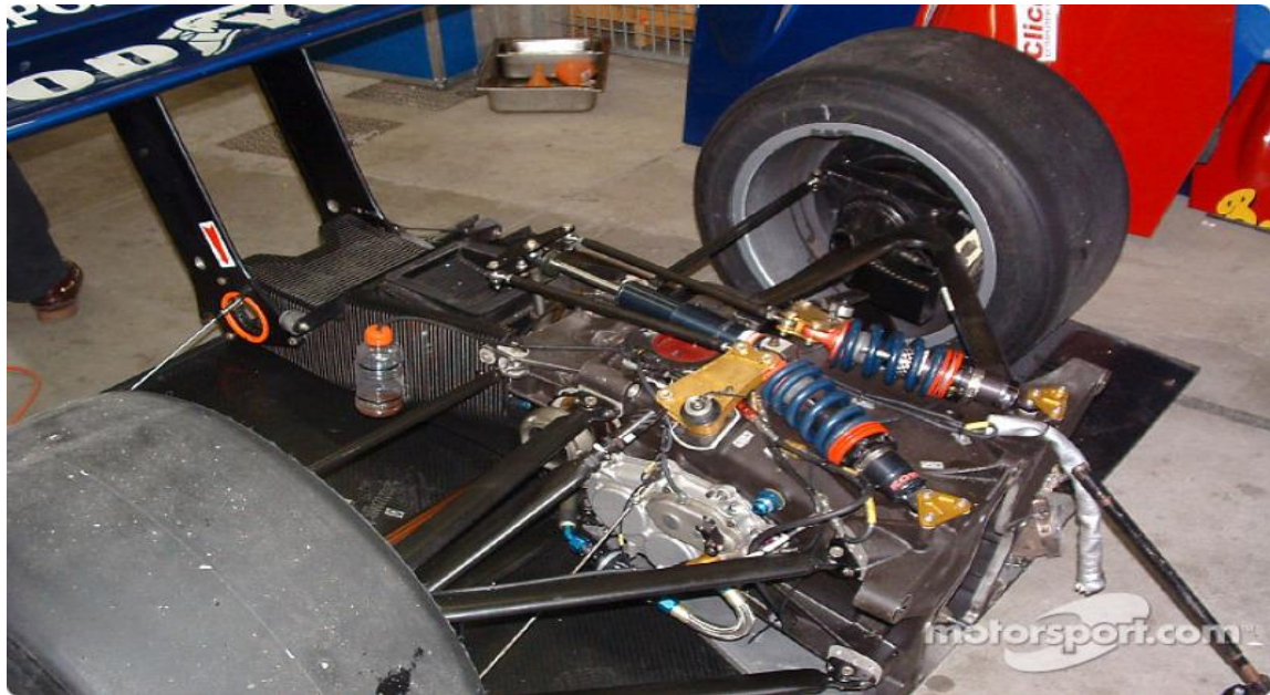
Sl.3.3. Stražnja suspenzija i mjenjač brzina [11]
