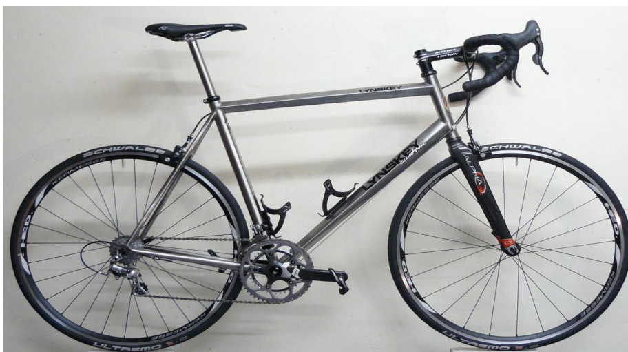
Sl. 3.23. Natjecateljski bicikl s okvirom izrađenim od TiAL6V4 legure titana [20]
