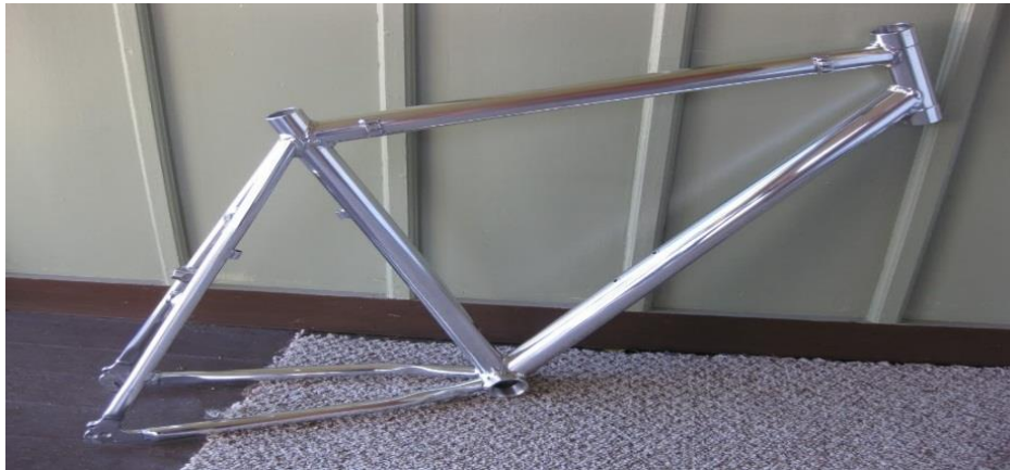
Sl. 3.20. Okvir bicikla izrađen od Al 7075 legure
