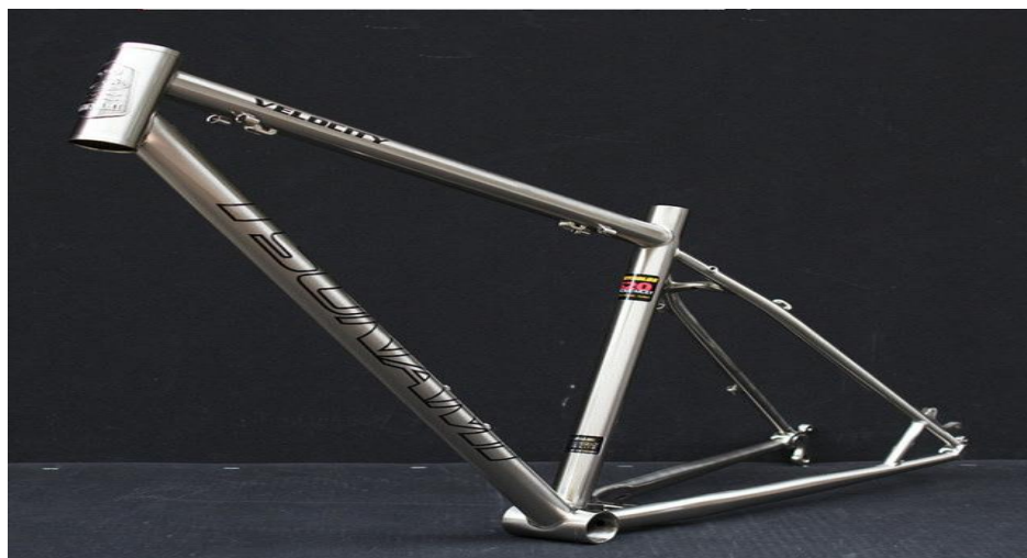
Sl. 3.21. Okvir izrađen od Reynolds 531 poboljšanog čelika [17]
