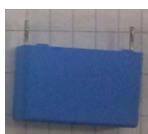
Slika 3.3 Blok kondenzator nazivnog kapaciteta 2.2μF
