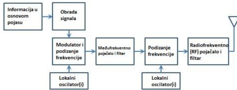
Slika 2.2. Blok dijagram komunikacijskog sustava zajedno s modulatorom [2]
