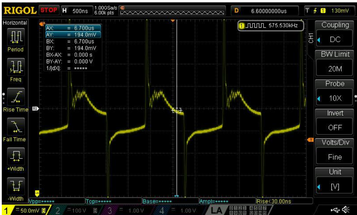
3.1.13 Izgled signala (pravokutnog) na izlazu iz derivatora mjernog kapaciteta 220pF( f=575,5\text{kHz} )
