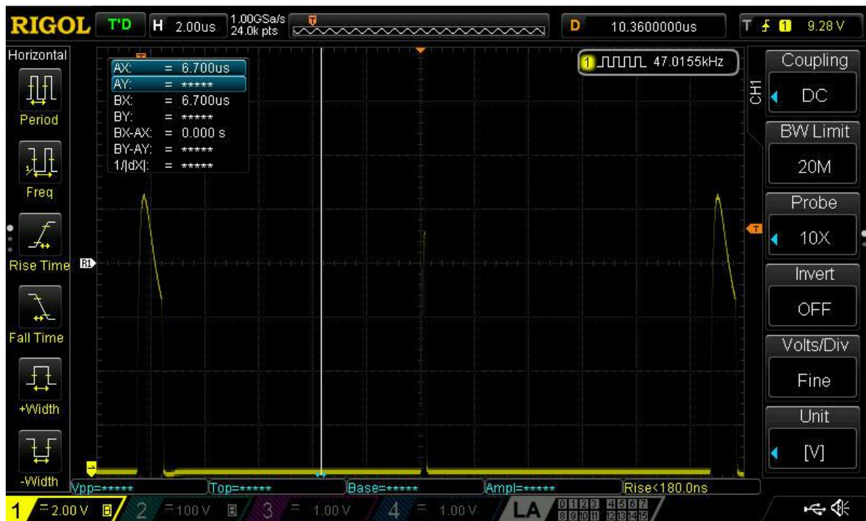
Slika 3.2.8-Signal poslije komparatora usljed djelovanja induktiviteta za kondenzator kapaciteta 56pF
