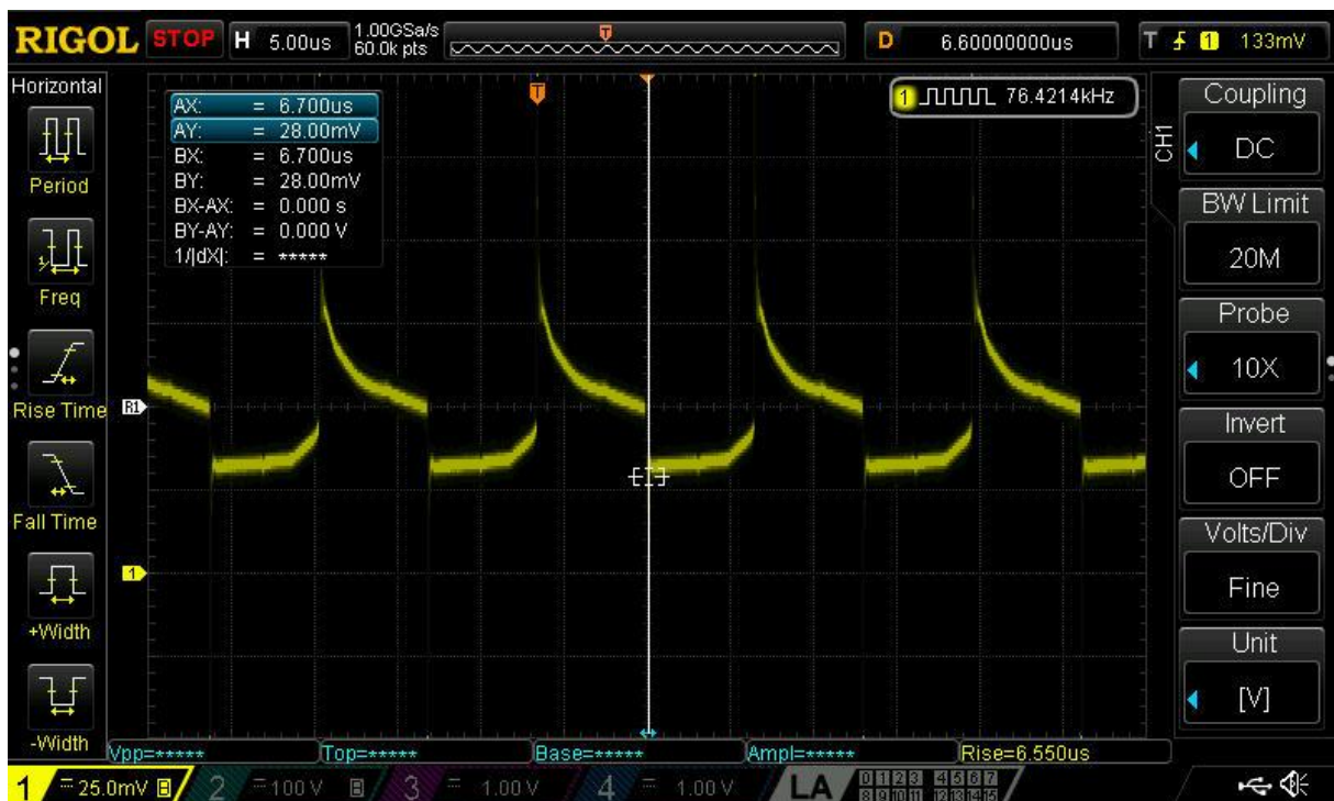
Slika 3.1.8 Izgled signala (pravokutnog) na izlazu iz derivatora mjernog kapaciteta 68pF ( f=76,42 kHz)
