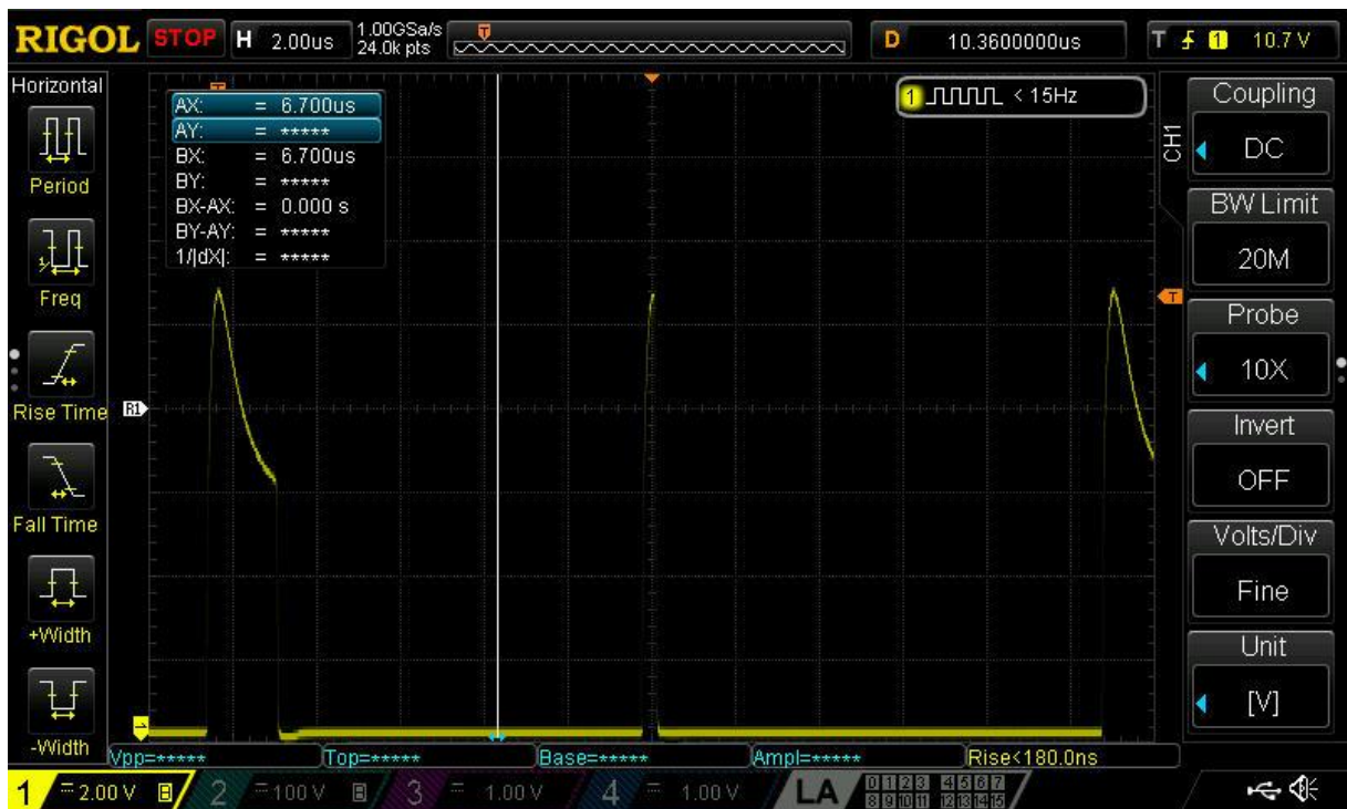
Slika 3.2.9-Signal poslije komparatora uslijed djelovanja induktiviteta za kondenzator kapaciteta 220pF
