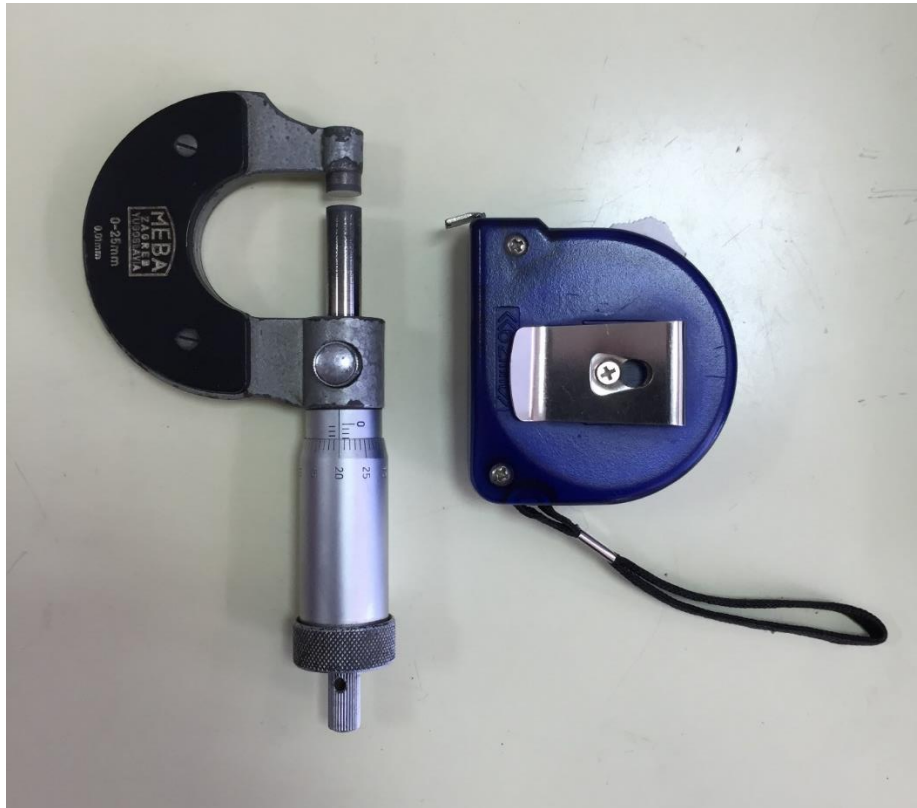
Slika 2.4. Mikrometarski vijak i mjerna traka
