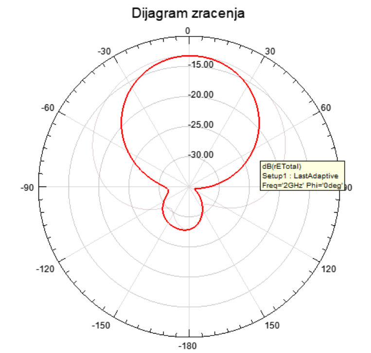
Sl. 5.2.1.10. Prikaz električnog polja u E ravnini na dijagramu zračenja
