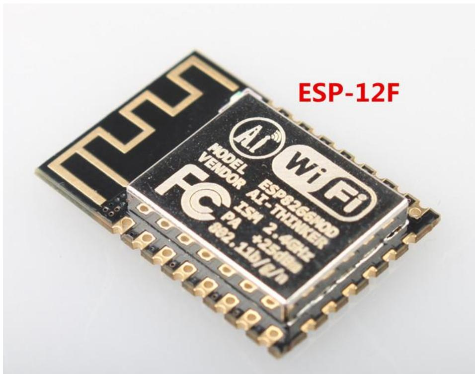
Slika 5. ESP8266 ESP-12F komunikacijski modul
