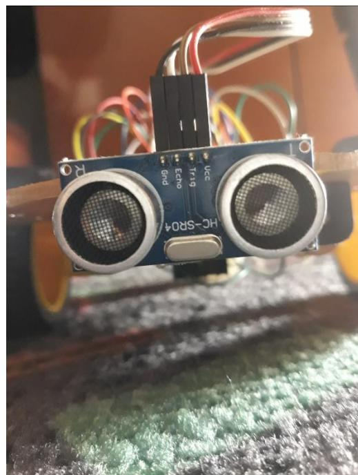
Slika 15. HC-SR04 senzor na robotskim kolicima
