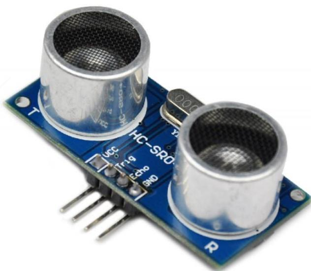
Slika 6. HC-SR04 ultrazvučni senzor
