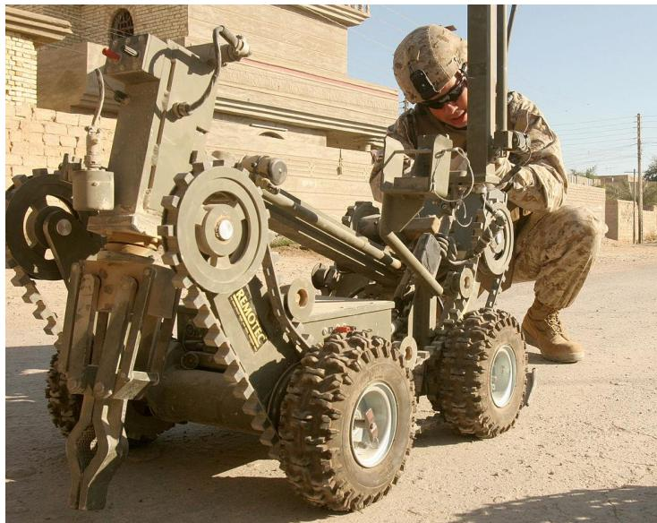
*Slika 1. Telemanipulator za istraživanje potencijalno eksplozivnih uređaja*
