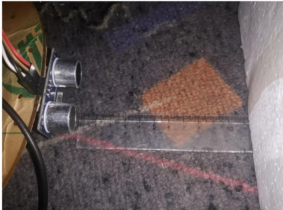
Slika 36. HCSR-04 senzor na udaljenosti od 11cm
