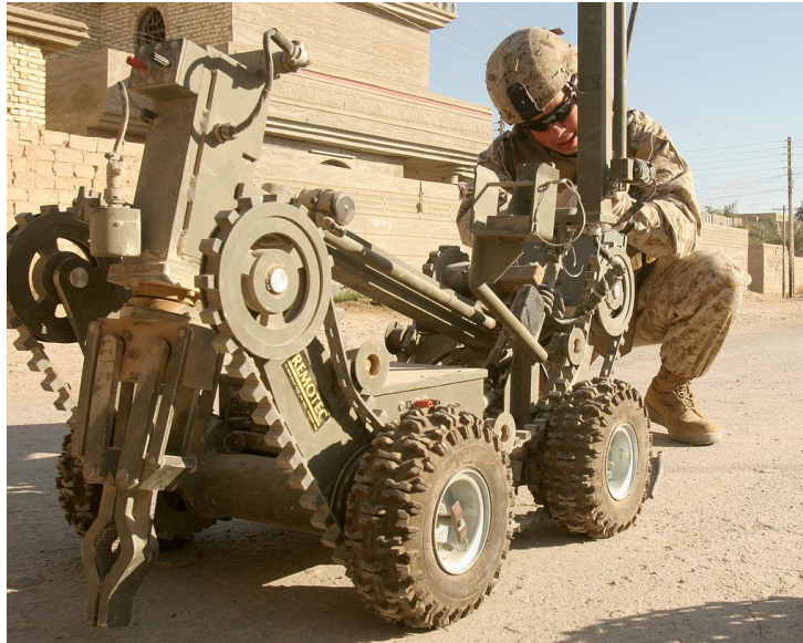
Slika 1. Telemanipulator za istraživanje potencijalno eksplozivnih uređaja
