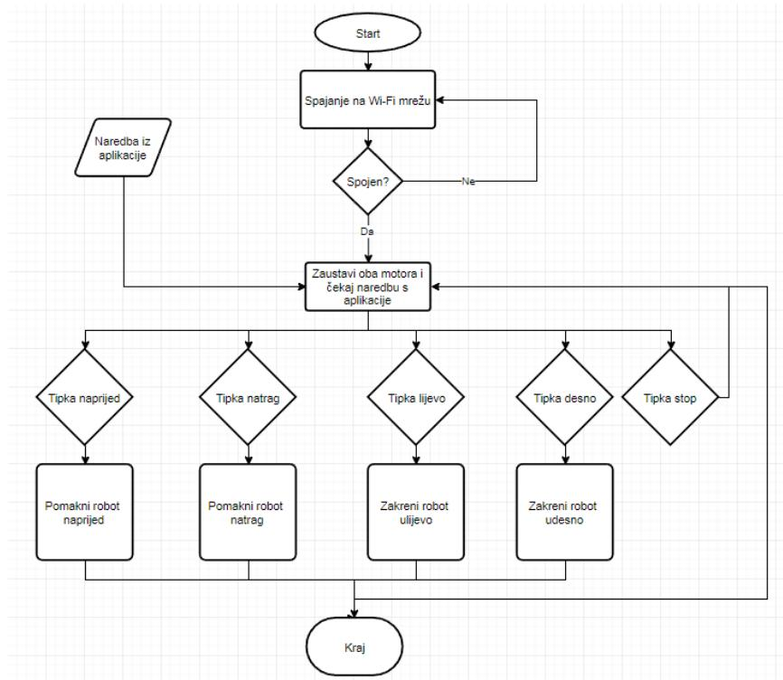
Slika 13. Blok dijagram upravljanja sustavom
