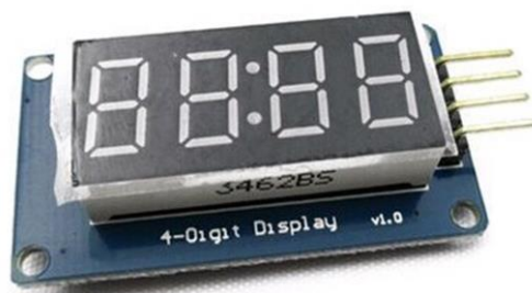
Sl. 4.4. Prikaz TM1637 7 segmentnog modula.
