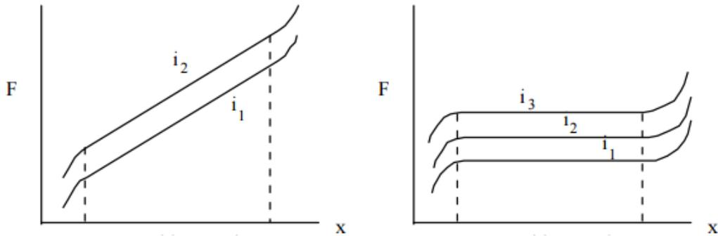
Slika 2.2. Omjer sile i pomaka ovisno o struji [1]
