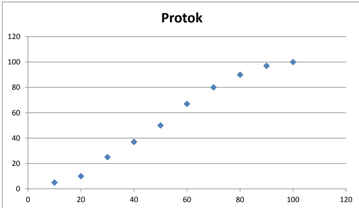
Slika 3.4. Uzorkovanje karakteristike ventila
