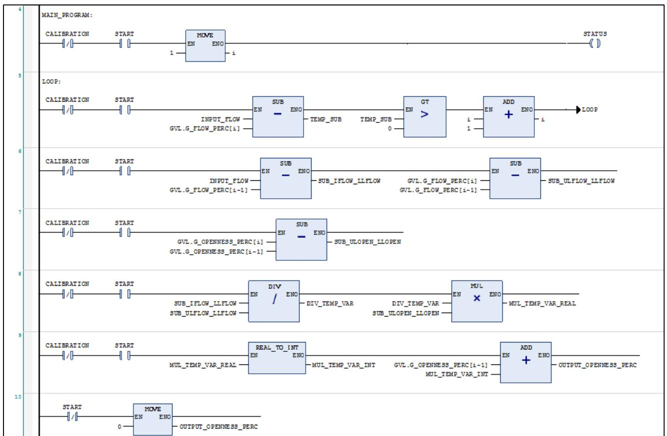
Slika 4.3. Program za upravljanje proporcionalnim ventilom u CODESYSu
