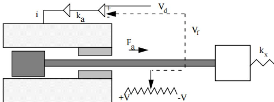
Slika 2.4. Pozicioniranje kominacijom opruge i povratnog signala [1]
