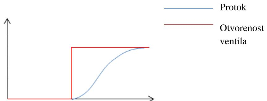
Slika 4.2. Promjena protoka u odnosu na skokovitu promjenu otvorenosti ventila
