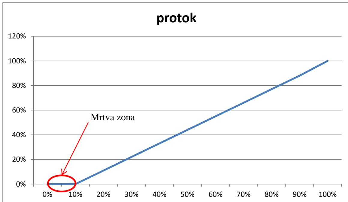
Slika 2.5. Model protoka ventila s mrtvom zonom
