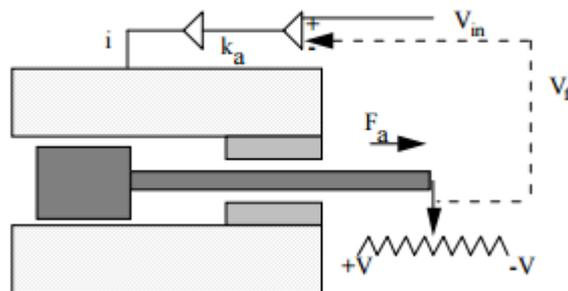
Slika 2.3. Pozicioniranje povratnim signalom [1]
