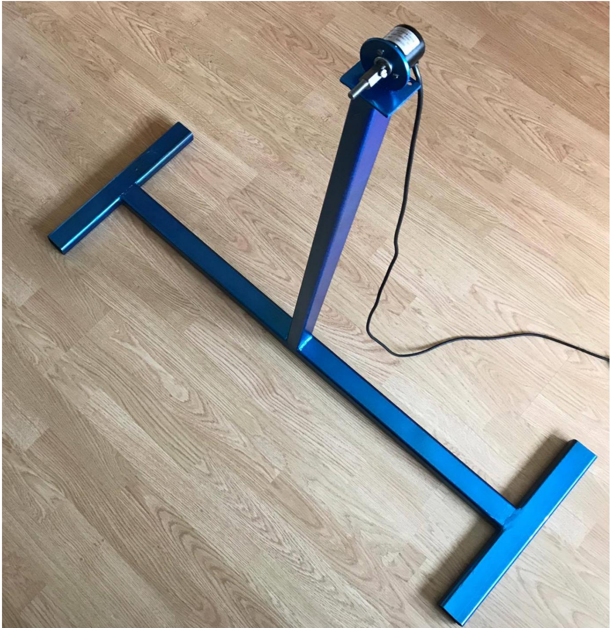
Slika 3.1. Stalak na koji je pričvršćen enkoder.
