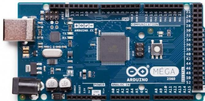
Slika 2.1. Arduino Mega pločica.
