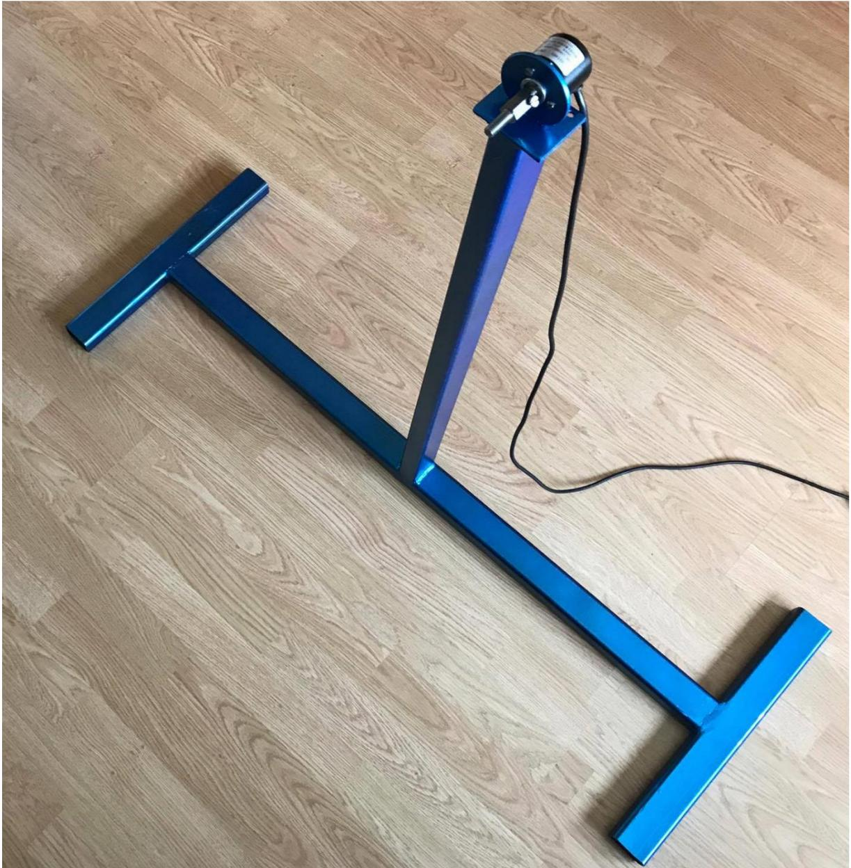
*Slika 3.1. Stalak na koji je pričvršćen enkoder.*
