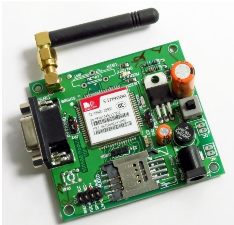
Sl. 3.3.: GSM modul za arduino. 4
