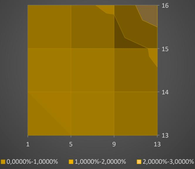
Sl. 4.18. Površinski grafikon koji prikazuje promjenu kapaciteta u odnosu na referentnu vrijednost bez predmeta, prikazan odozgo.
