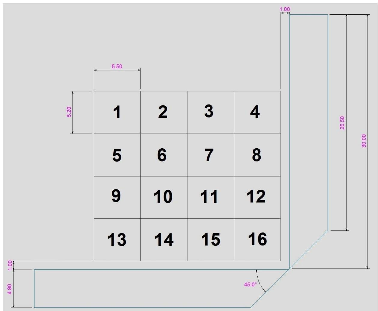
Sl. 4.6. Prikaz senzorskih elektroda s obzirom na mjeru mrežu u mjerilu.
