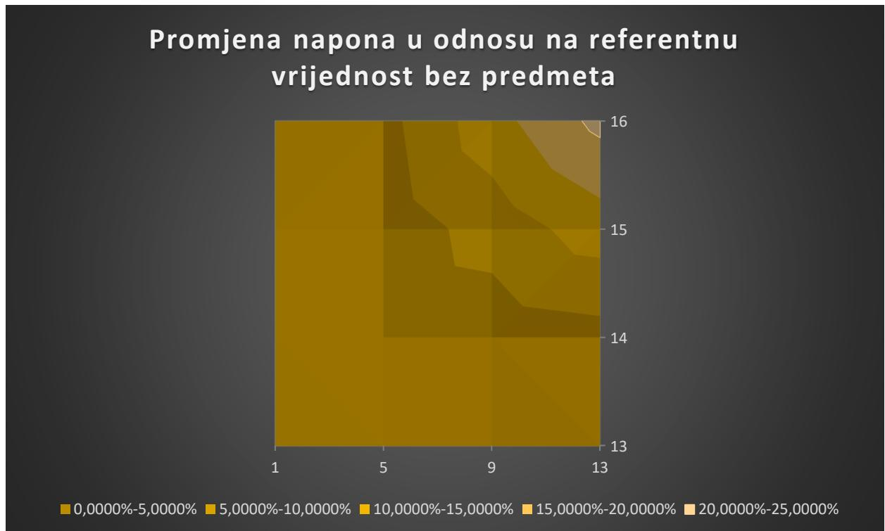
Sl. 4.15. Površinski grafikon koji prikazuje promjenu napona u odnosu na referentnu vrijednost bez predmeta, dvodimenzionalni prikaz.
