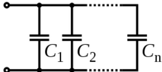
Sl. 2.7. Paralelni spoj kondenzatora u mreži [9].
