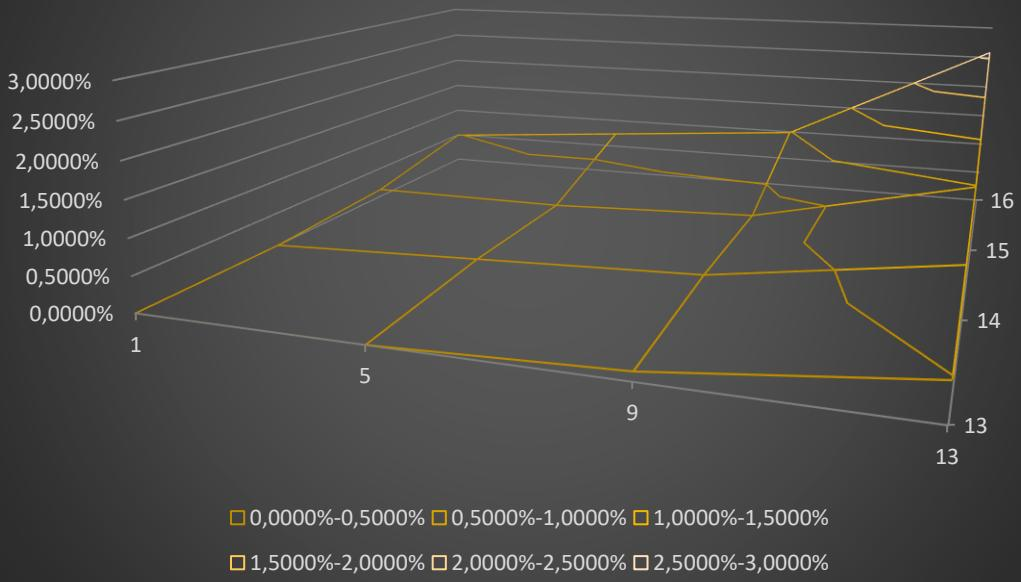
Sl. 4.7. Površinski grafikon koji prikazuje promjenu kapaciteta u odnosu na referentnu vrijednost bez predmeta, trodimenzionalni prikaz.
